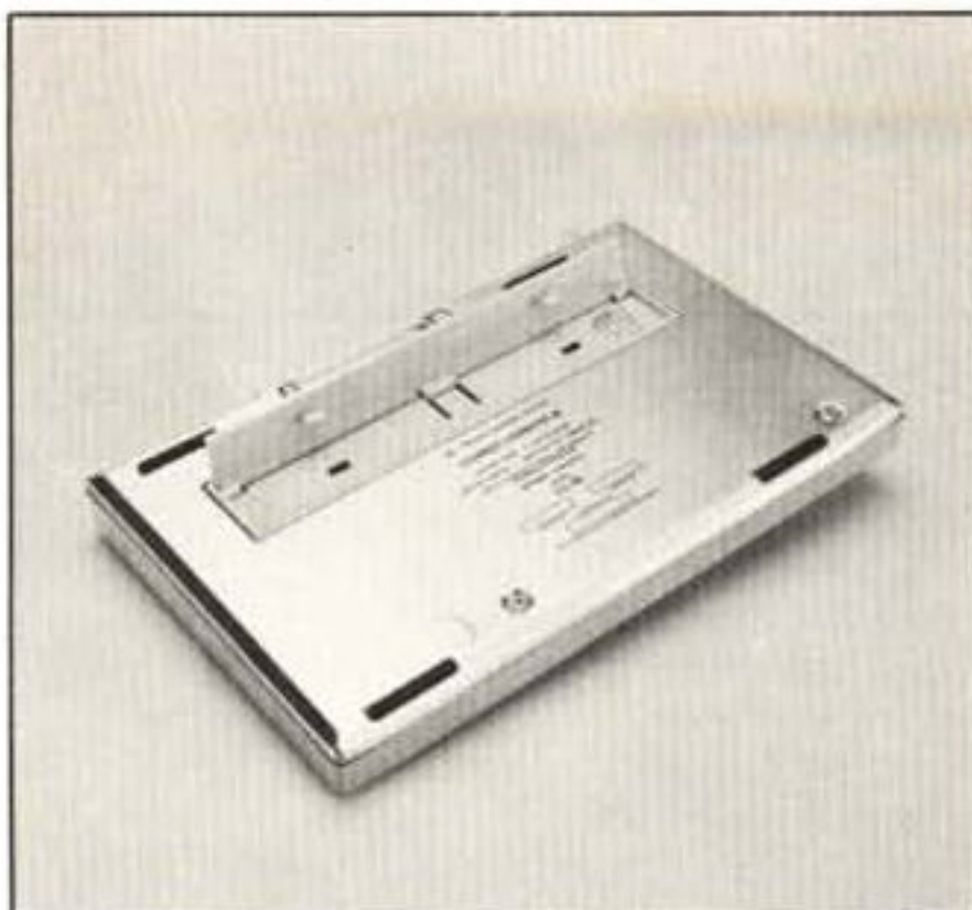
Sul pannello posteriore del computer è situata una barra di plastica incernierata sul fondo, per permettere un posizionamento inclinato del CC-40.
