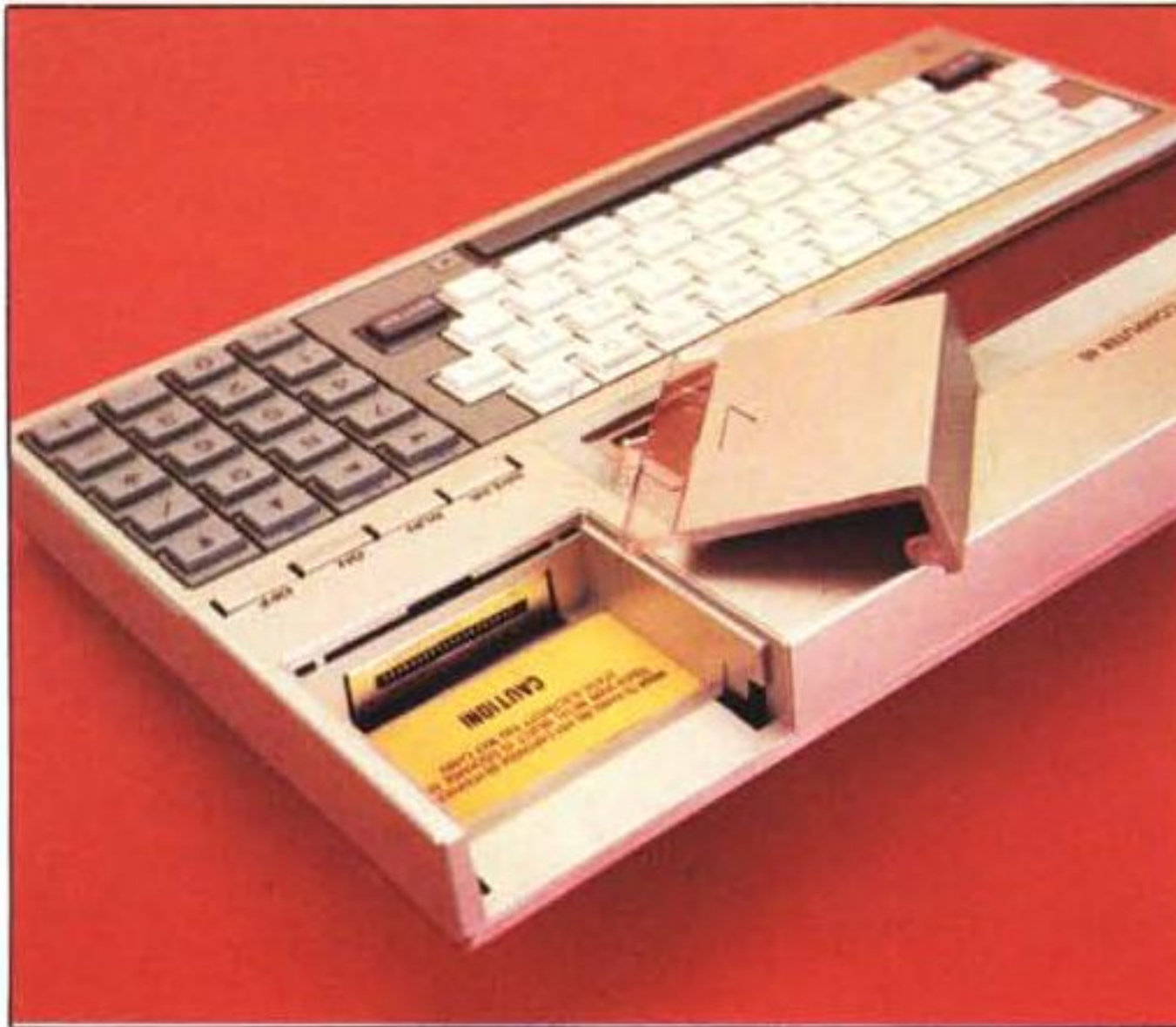
A fianco del display è situato l'alloggiamento per i moduli Solid State Software e per le espansioni RAM.
