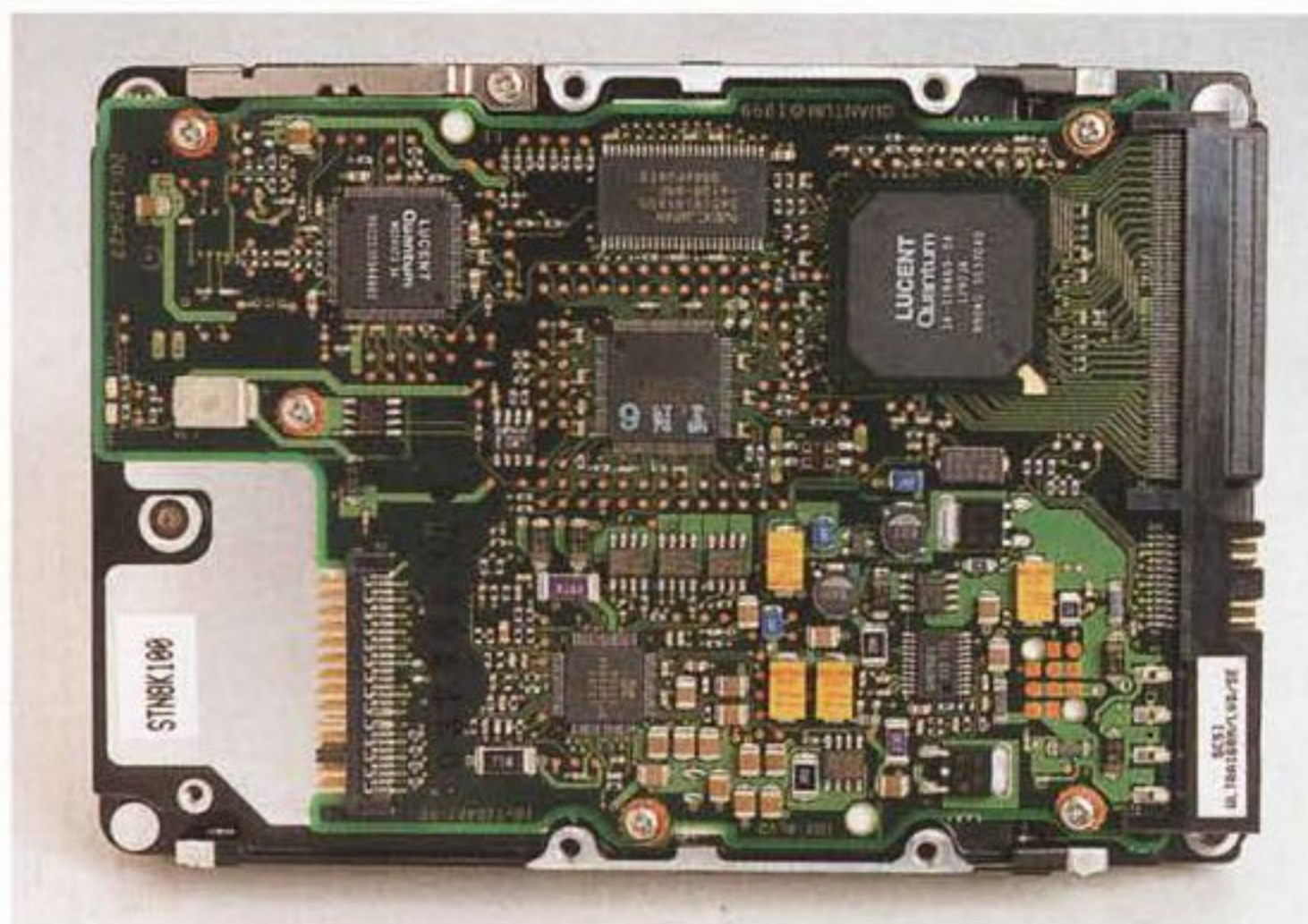
Il disco rigido Quantum Atlas 10K, a 10.000 giri al minuto e 9 Gbyte di capacità.
