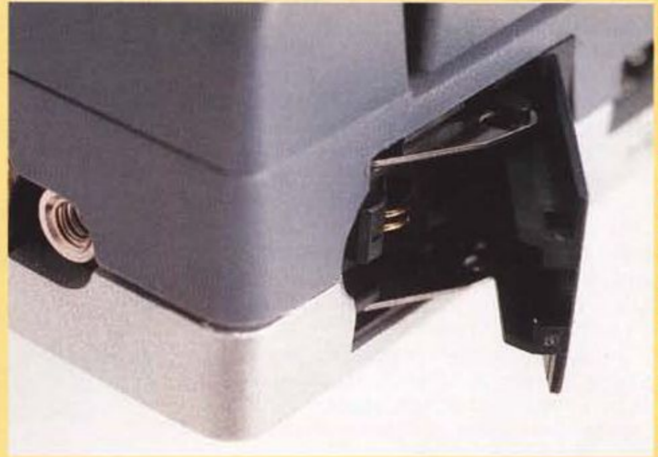
Una porta RJ11 a scomparsa per il collegamento del modem interno al notebook alla rete telefonica.
