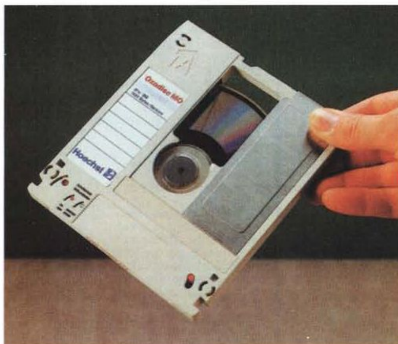
I primi dischi magneto ottici, dimensioni 5"1/2, capacità 650MB, riscrivibili su ambedue i lati. Un bel salto nella scalata dei Megabyte, ma il driver costa la bellezza di una diecina di milioni!
