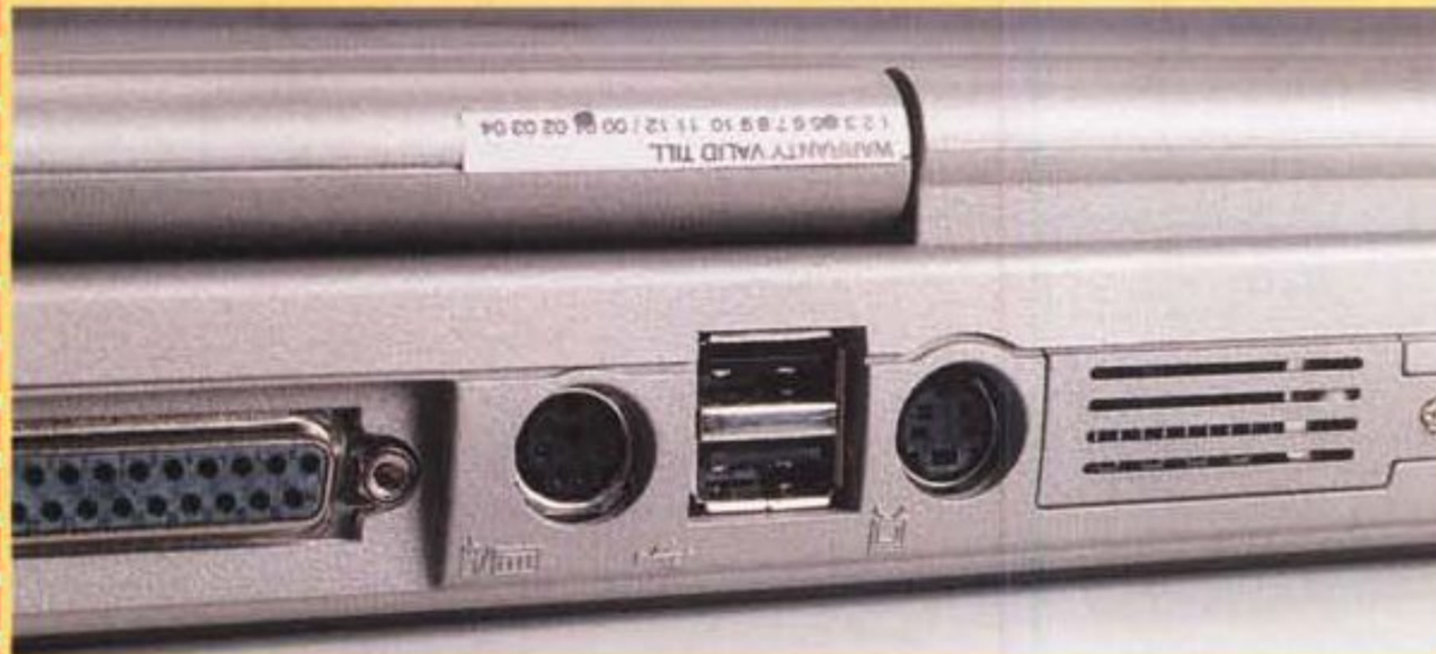
Una doppia porta USB con al lato destro l'uscita SVHS; a sinistra è presente un connettore per tastiera/mouse esterni. Una nota a proposito di quest'ultima porta: è possibile collegare contemporaneamente sia la tastiera, sia il mouse, solo tramite un apposito cavetto ad Y, piuttosto costoso e che non viene quasi mai fornito assieme al portatile.
