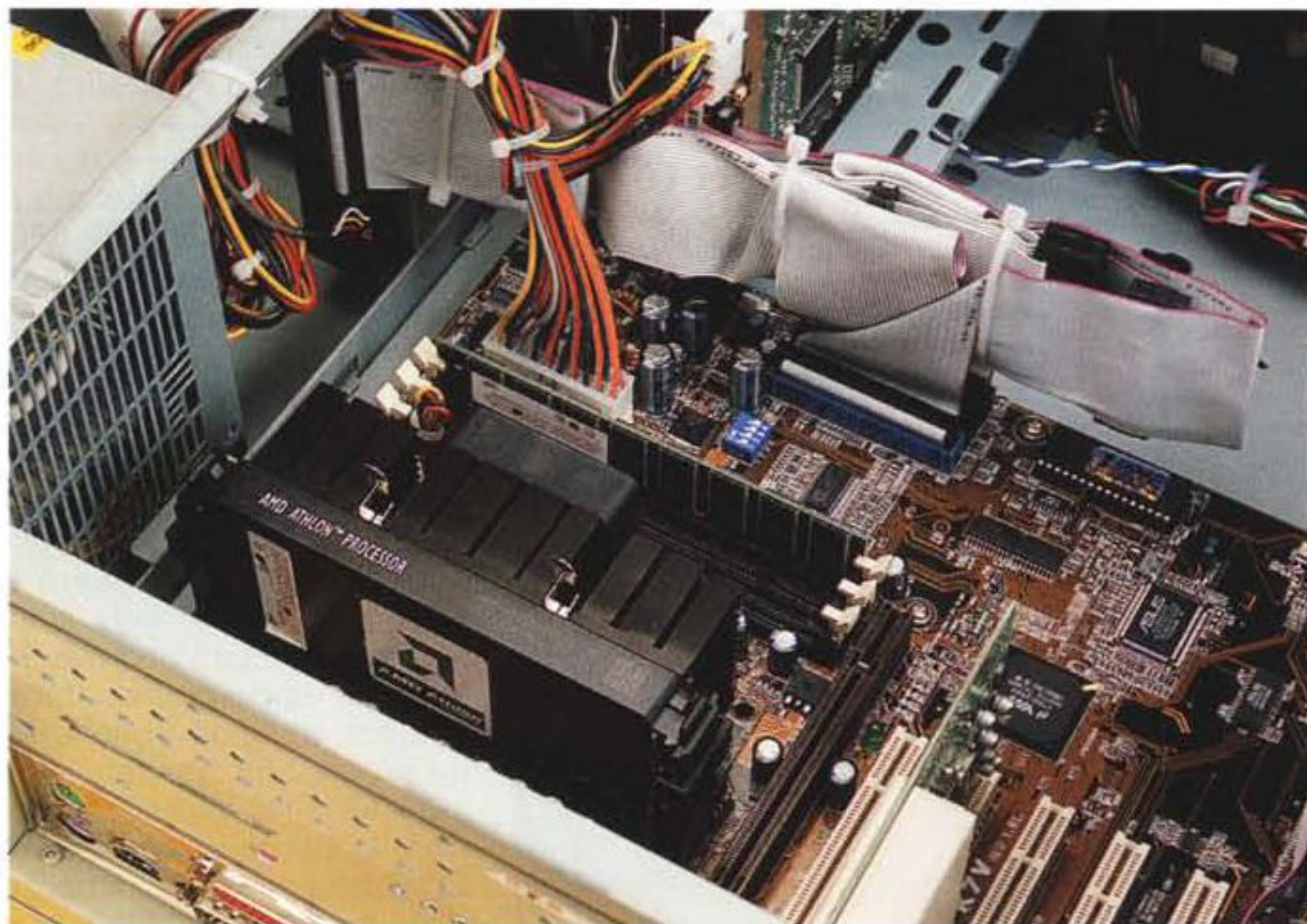
Particolare della nuova scheda madre di produzione Asus, la K7V dotata di chipset Via KX133, con l'acceleratore grafico rimosso: si notano lo slot AGP 4X, gli slot DIMM liberi e il massiccio dissipatore corredato dei ventolina del processore Athlon a 850 MHz.
