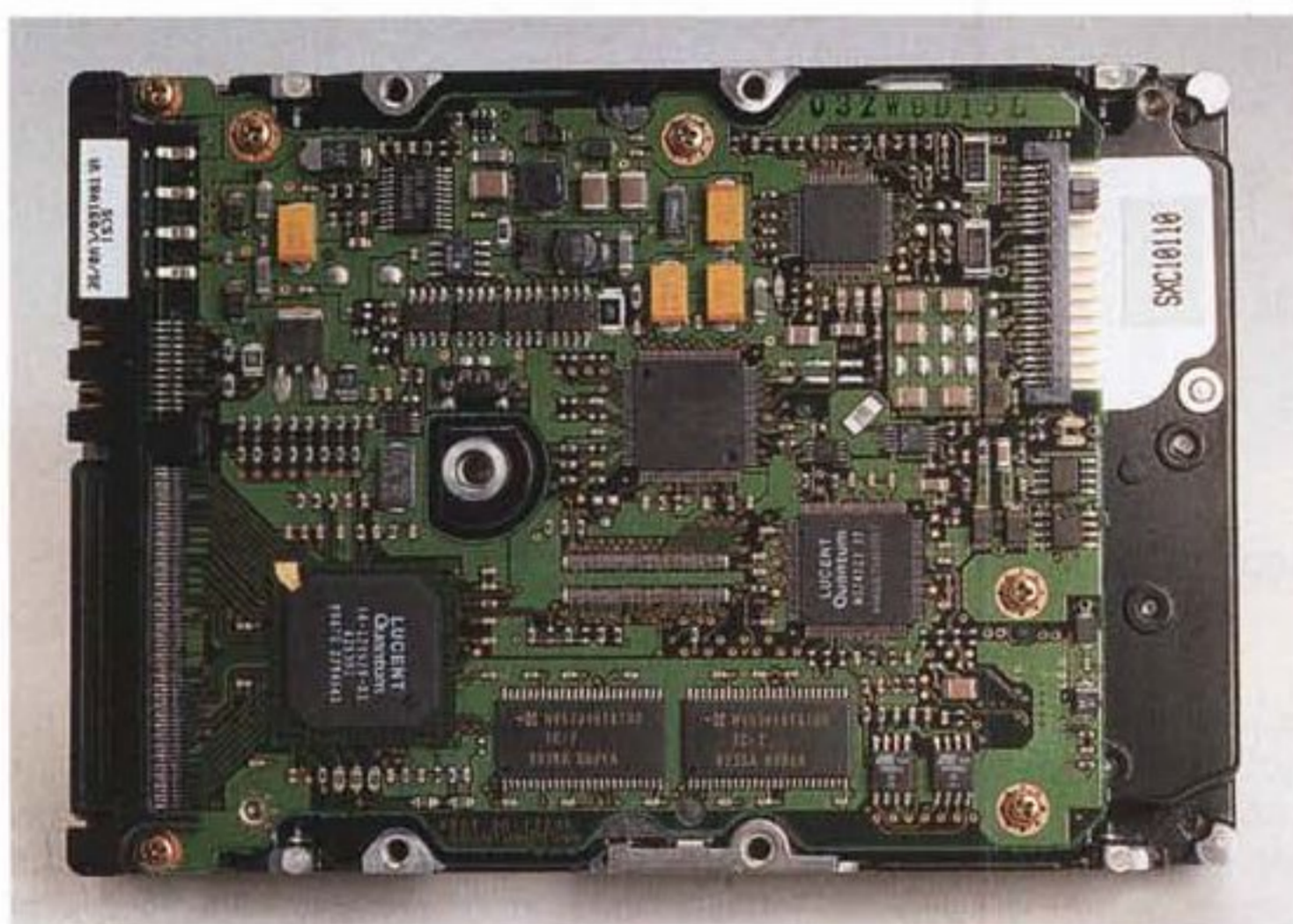
Il disco rigido Quantum Atlas V, a 7.200 giri al minuto e 18 Gbyte di capacità.
