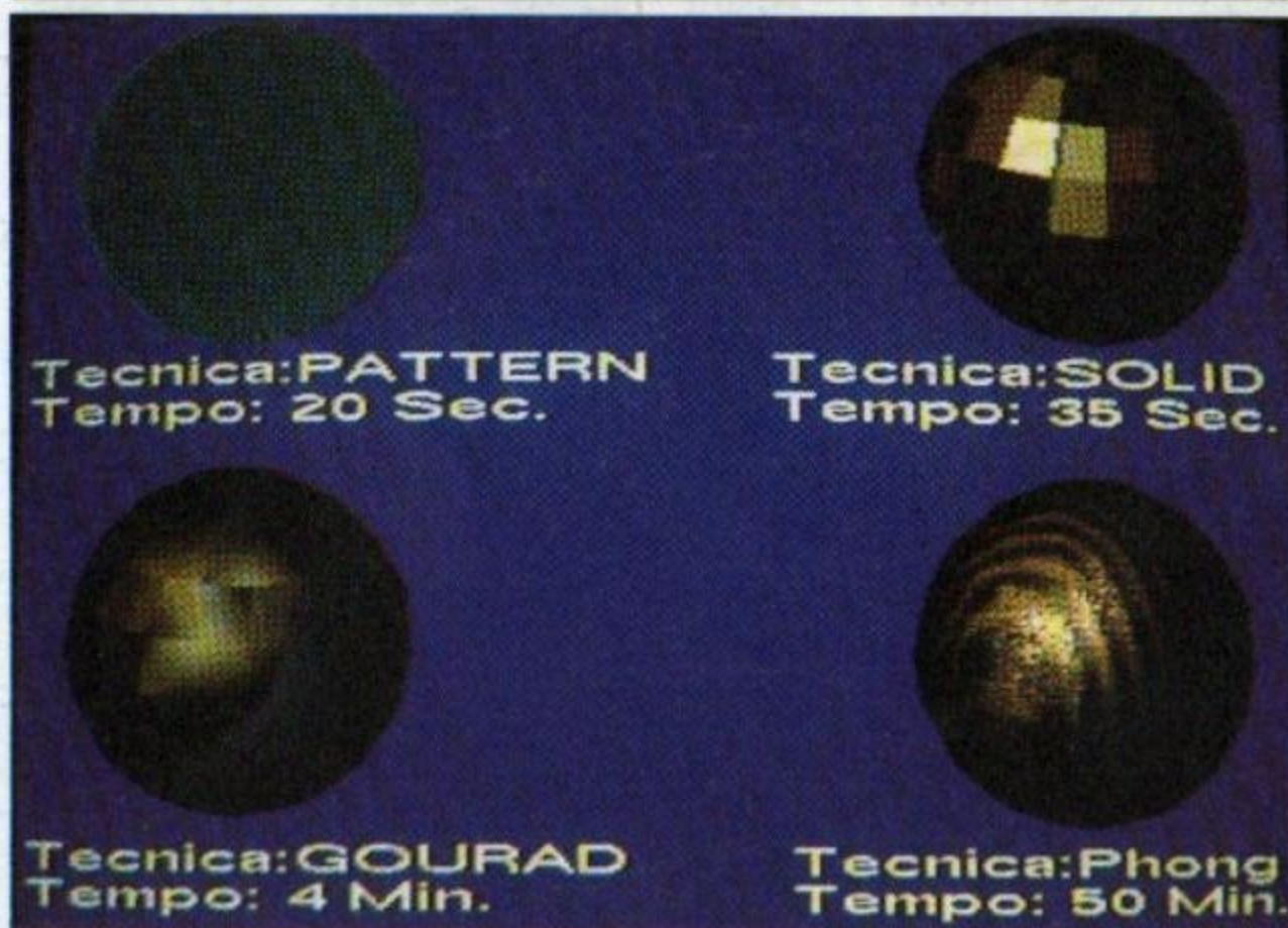
Fig. 4. Nell'esempio l'oggetto è stato calcolato impiegando quattro algoritmi diversi. I tempi aumentano in proporzione alla complessità.
