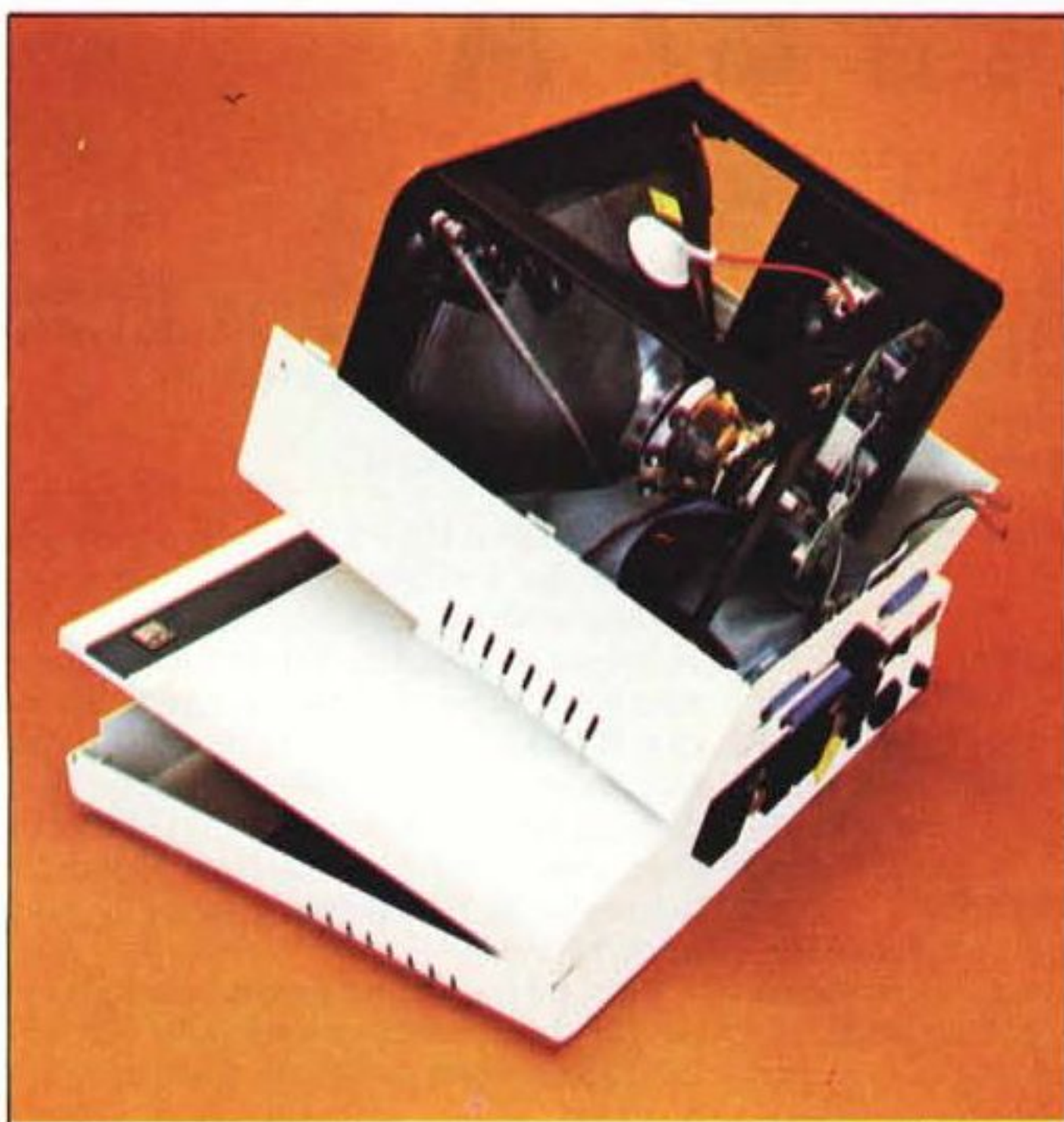
La macchina semiaperta; il monitor è fissato rigidamente al coperchio dell'unità centrale. A destra, il marchietto GP.
