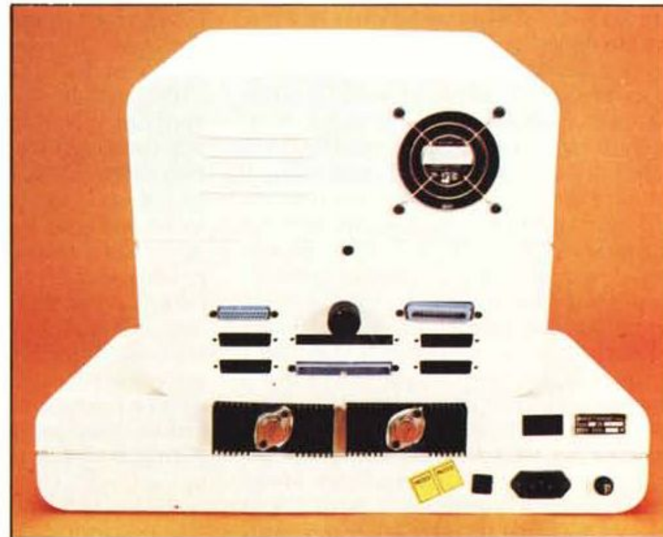
Il contenitore è in due parti: una comprende il monitor e l'unità centrale, l'altra la tastiera. Il design è molto curato, la realizzazione in metallo verniciato bianco.
