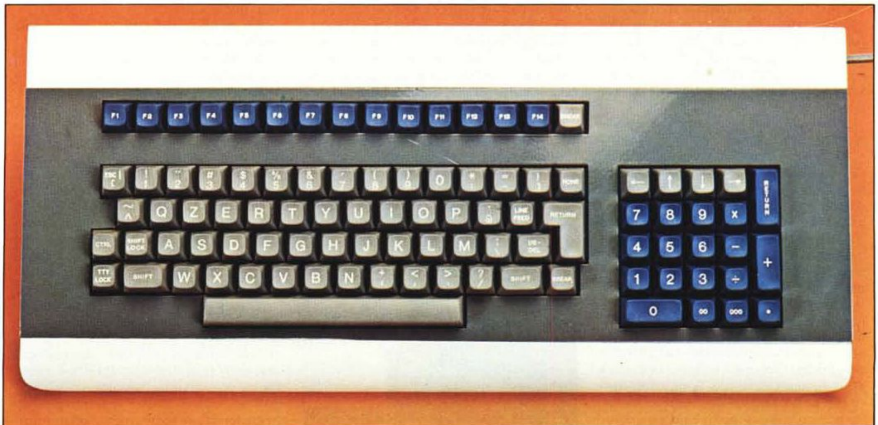
I tasti sono 94. Notare il doppio e triplo zero sul tastierino numerico e la fila di tasti funzione in alto.
