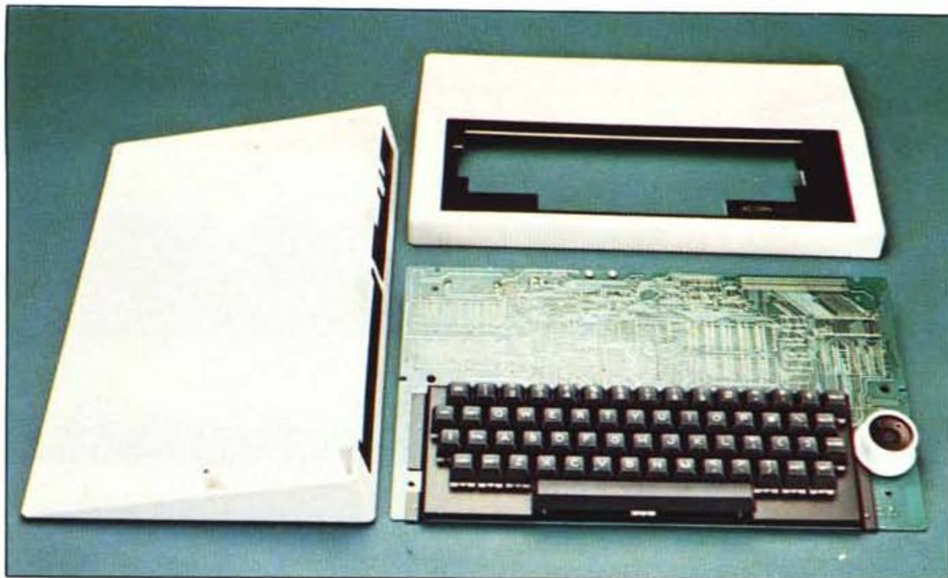
L'Atom è costituito da un'unica piastra. Su un lato è fissata la tastiera, sull'altro tutti i componenti.
