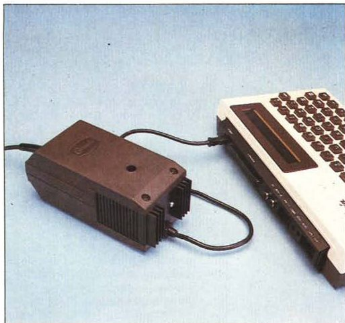
Sopra, l'alimentatore esterno: è ben visibile l'aletta di raffreddamento. A destra un particolare del modulatore Rf posto nella scheda della tastiera.
