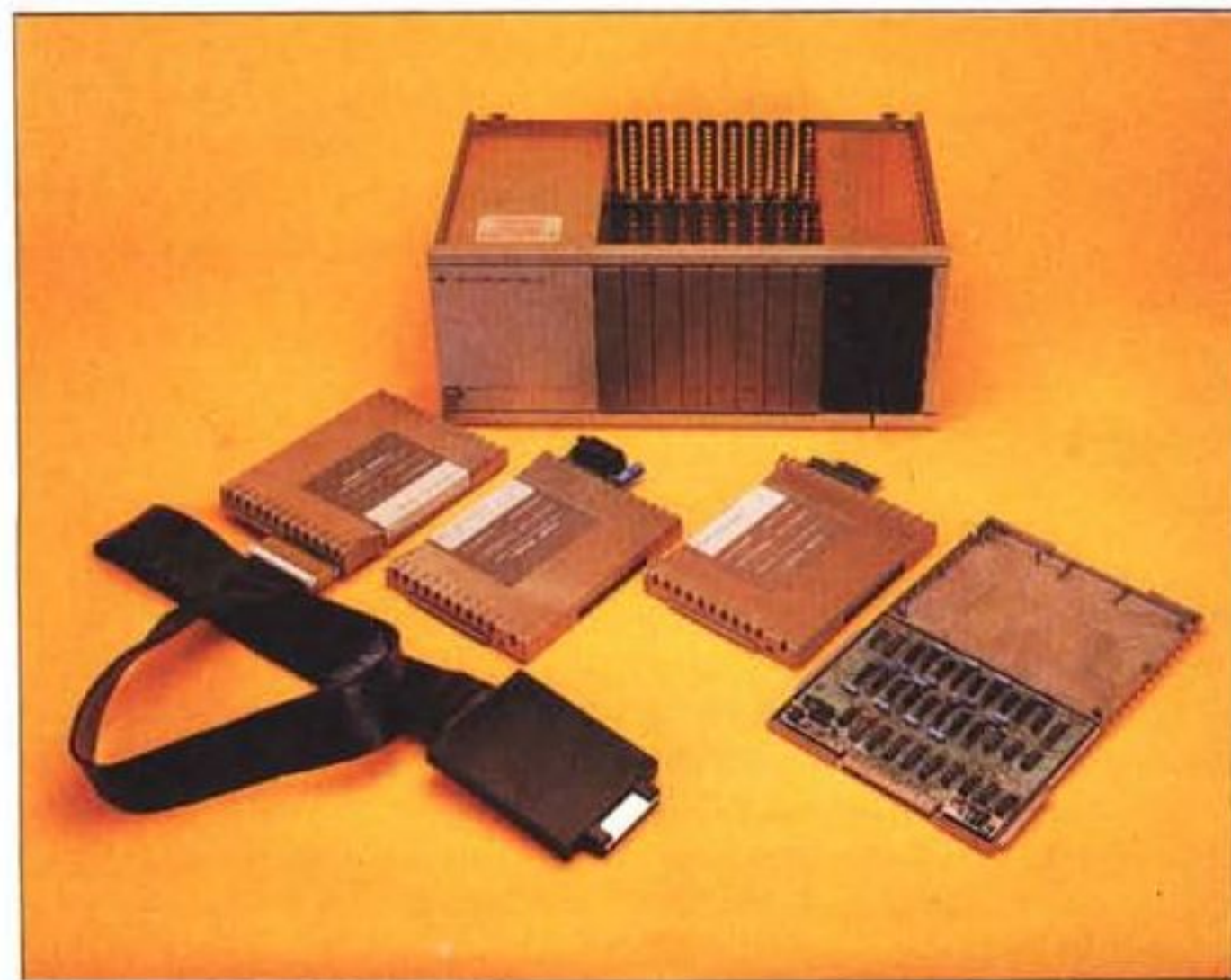
Il sistema di espansione nelle sue componenti. Da sinistra: scheda di interfaccia con la consolle, scheda RS232, disk controller e, aperta, la RAM da 32K. Sullo sfondo il rack che oltre a contenere le schede, fornisce loro l'alimentazione.
