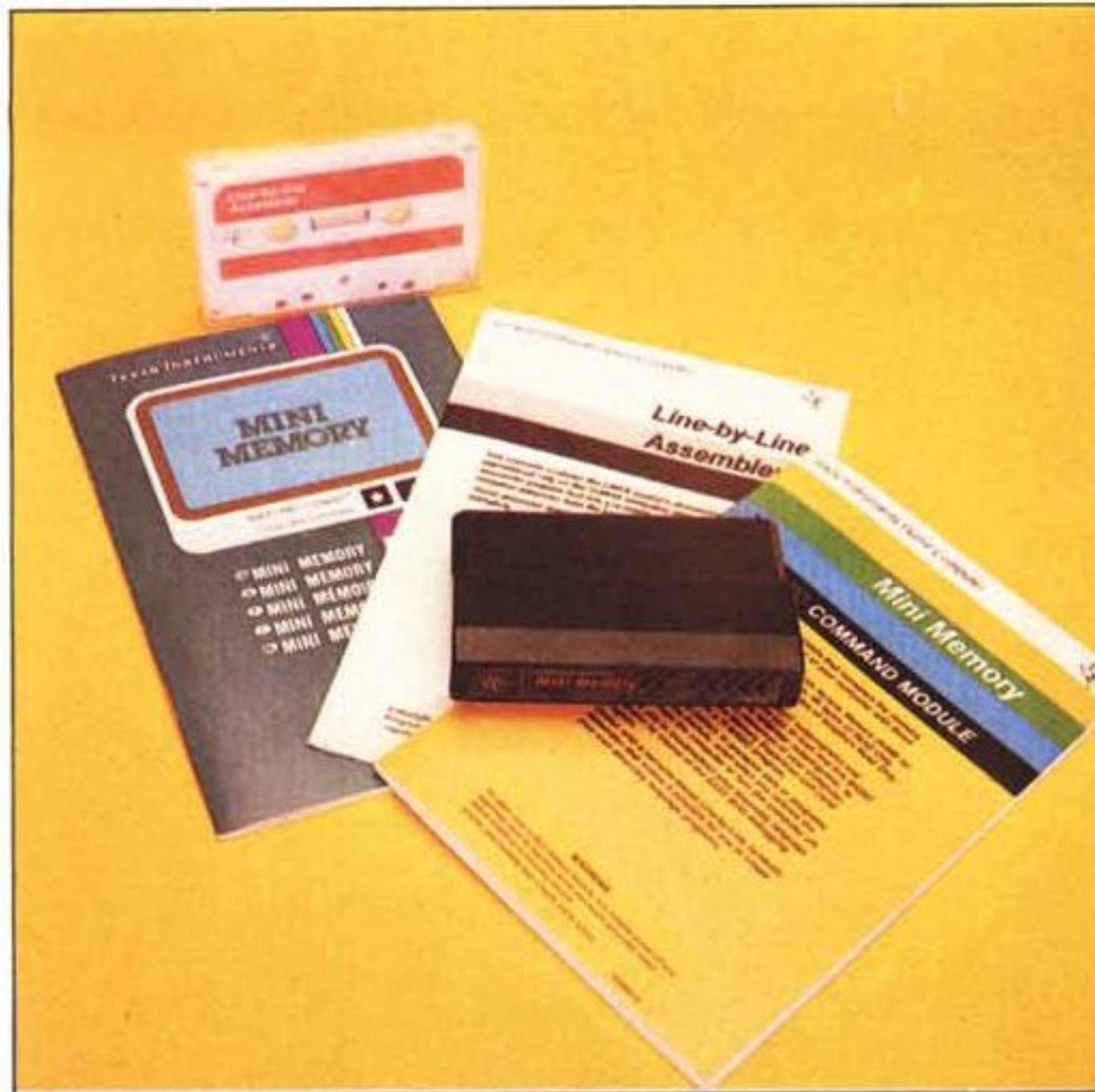
Il modulo mini-memory con la documentazione tecnica (scarsa) e la cassetta contenente il programma assembler line by line. Senza il manuale dell'editor assembler il suo utilizzo è problematico.
