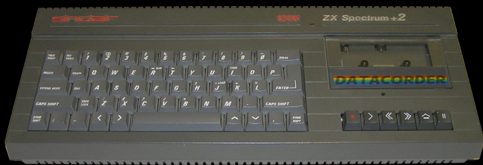
Lo Spectrum +2 a 128K con registratore a cassette integrato. Il primo modello nato dal matrimonio Sinclair / Amstrad
