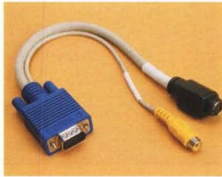
Il cavetto di interfacciamento a corredo della scheda grafica, pressoché identico a quello della serie G400 DH: consente di pilotare periferiche di visualizzazione S-VHS o Videocomposito
