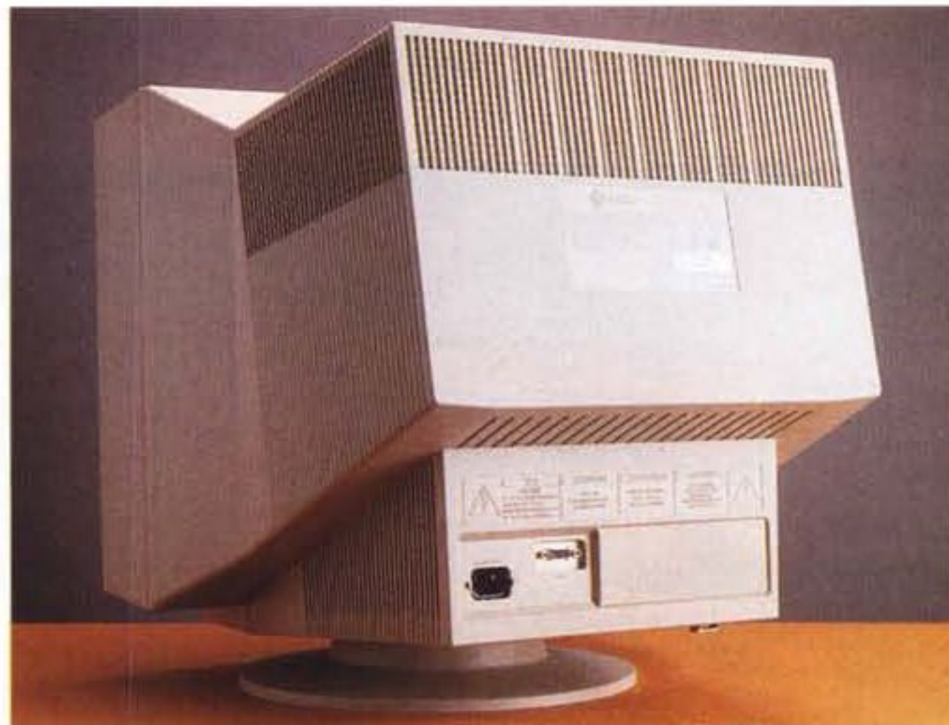
Il pannello posteriore del monitor, con il connettore D-Sub a 15 poli e l'ingresso per la rete elettrica.
