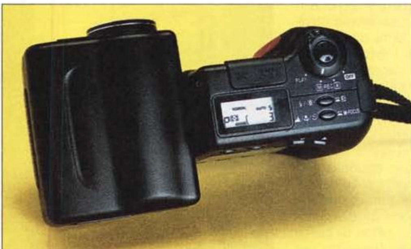
La COOLPIX 950 è incernierata al centro per mezzo di uno snodo. Grazie a questo è possibile scattare fotografie agevolmente in ogni condizione di utilizzo, anche le più scomode (ad esempio inquadrature dall'alto, a mani tese, o dal basso, raso terra).
