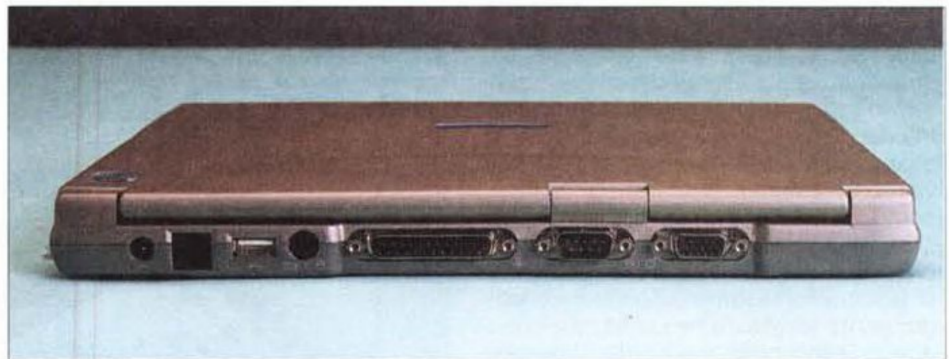
Il retro del notebook. È interessante notare il rapporto di spessore tra il display e i connettori; praticamente la porta parallela ha lo stesso spessore del primo!
