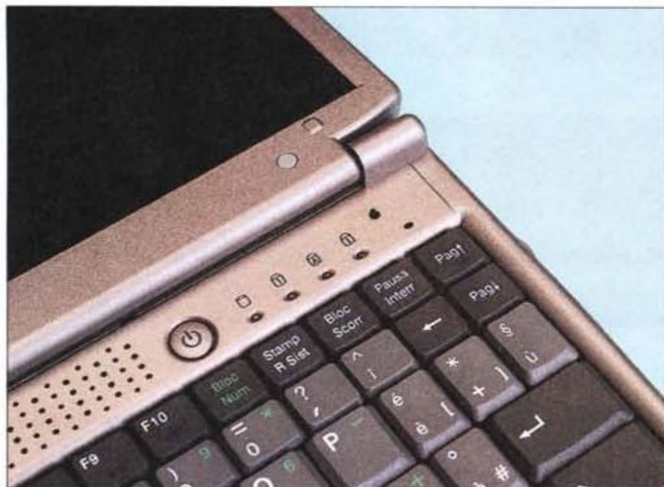
Particolare della tastiera con il gruppo dei LED di stato e il pulsante di accensione; sulla destra si può notare il piccolo "sensore" che mette in stand-by la macchina quando si chiude il display e il forellino del microfono.
