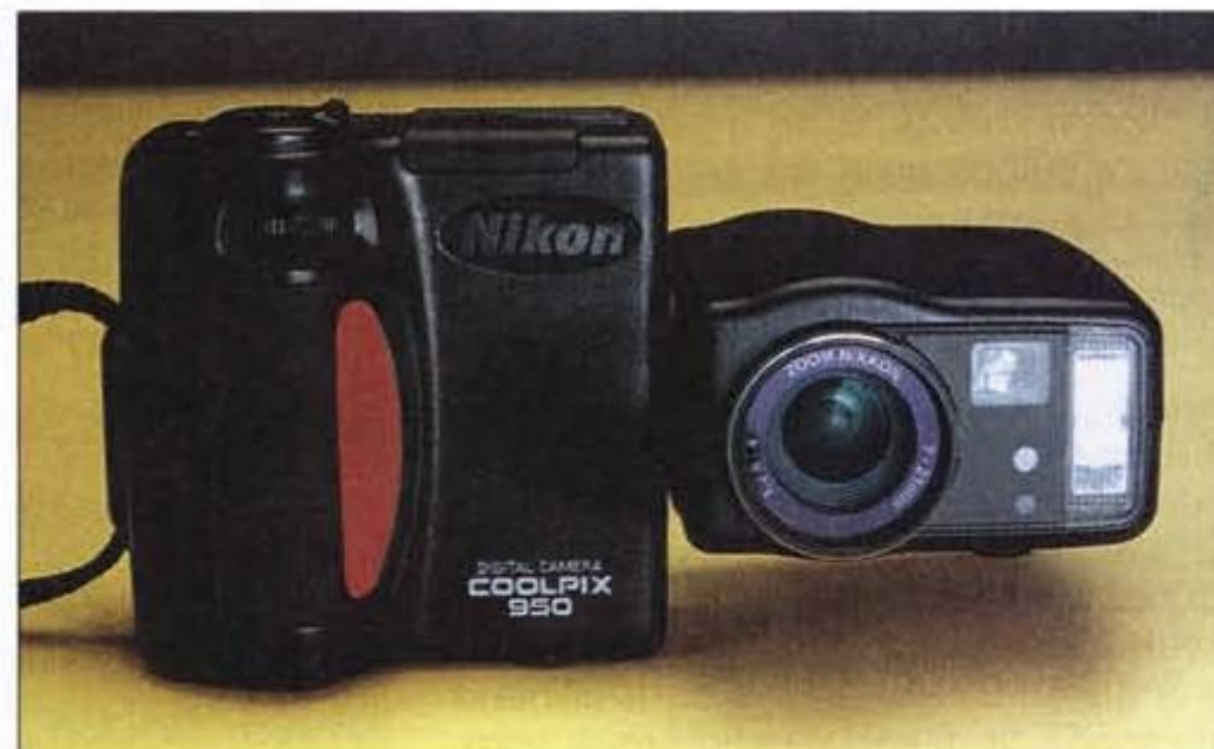
La COOLPIX 950 è incernierata al centro per mezzo di uno snodo. Grazie a questo è possibile scattare fotografie agevolmente in ogni condizione di utilizzo, anche le più scomode (ad esempio inquadrature dall'alto, a mani tese, o dal basso, raso terra).
