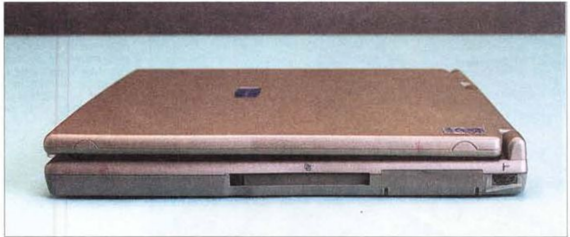
Lato destro del Folio: si notano lo slot per una PC-Card di tipo II, lo sportellino che cela il connettore per il lettore esterno di CD-ROM e la porta ad infrarossi.
