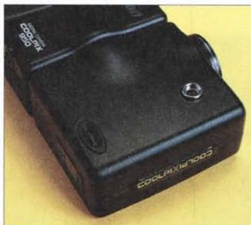
L'ingresso per l'alimentatore esterno, l'uscita video PAL, l'alloggiamento per la Compact Flash (BMB standard). A destra, sul fondo della macchina, la regolazione diottrica del mirino e il contatto (proprietario) per il flash TTL esterno.
