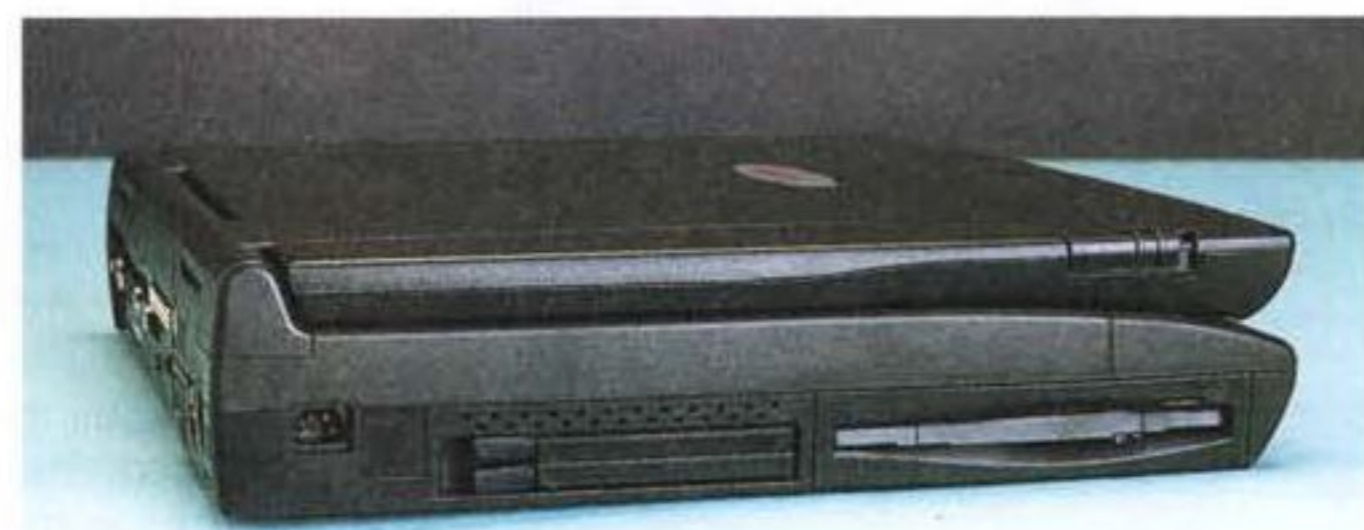
Lato sinistro: il connettore di alimentazione, le porte PCMCIA, e il floppy; il quadratino all'estrema sinistra è la predisposizione per il modem
