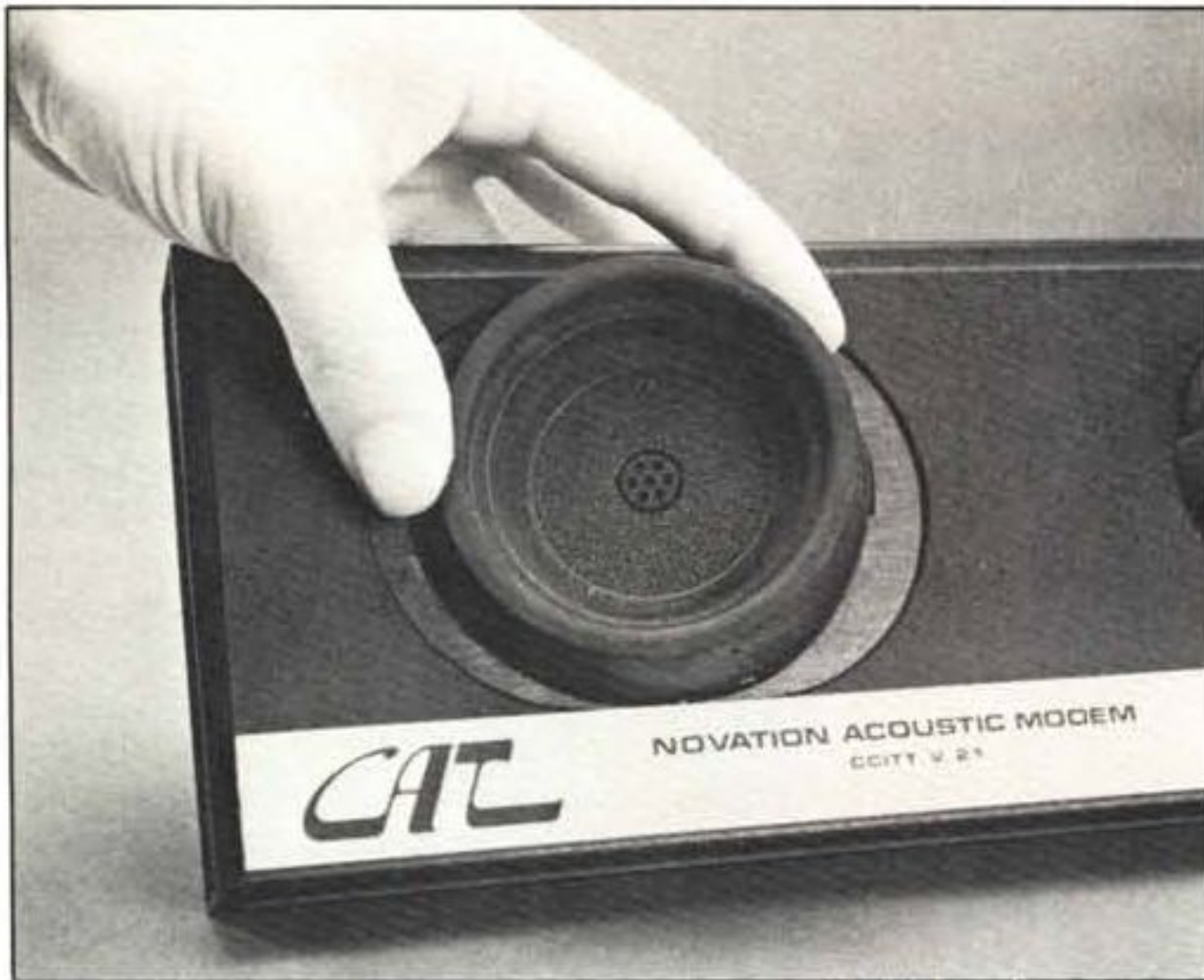
Foto 4 - Un aspetto molto interessante del modem NOVATION CAT è il fatto che le cuffie per l'inserimento del ricevitore del telefono sono orientabili, e consentono così un perfetto accoppiamento con qualsiasi telefono.
