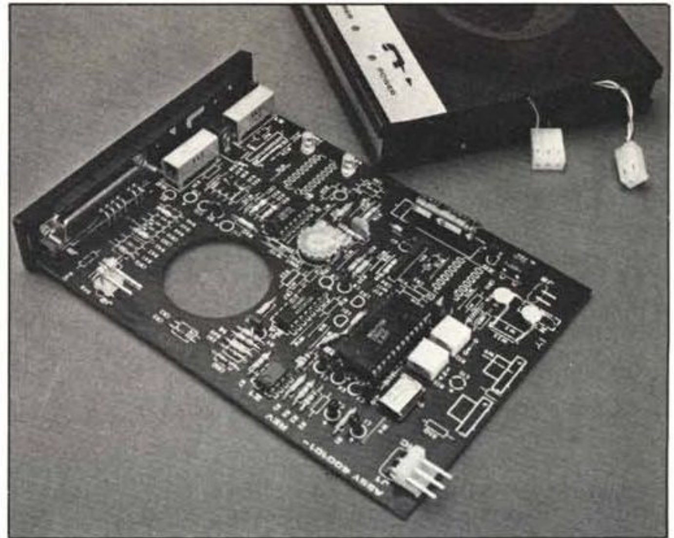
Foto 5 - Tutta l'elettronica del NOVATION CAT è raggruppata su un unico circuito stampato in vetronite sul quale sono saldati direttamente i connettori ed i deviatori. In questo modo l'unico cablaggio è quello relativo ai collegamenti al microfono e all'altoparlante che sono effettuati tramite due connettori.
