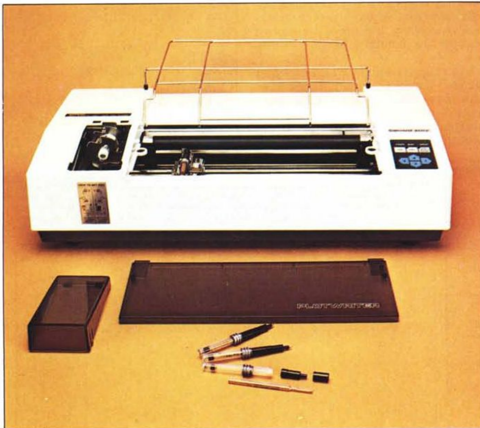
Sopra, una vista del plotter con le penne biro. A destra la tastiera a membrana: molto bella ma con troppe funzioni multiple.
