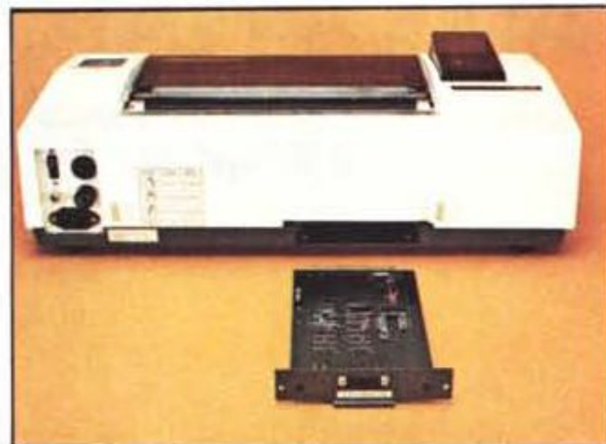
Il retro del plotter con la scheda d'interfaccia e il suo alloggiamento.
