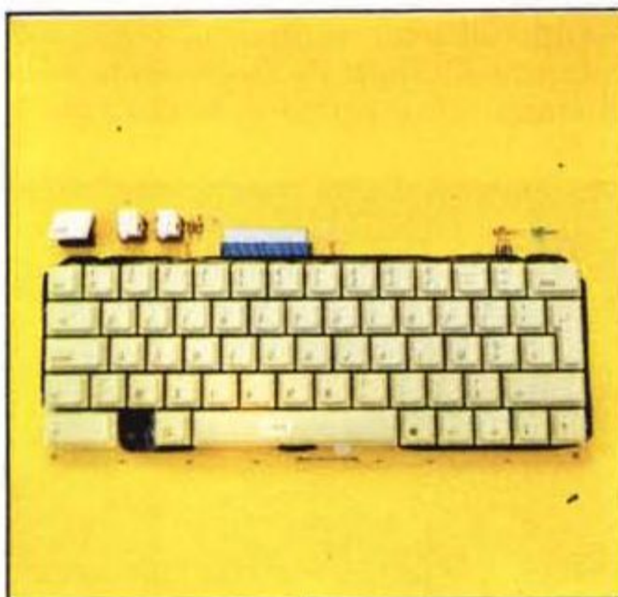
Sulla piastra della tastiera sono disposti solo i tasti e i led. Tutta l'elettronica di gestione si trova sulla scheda del computer.
