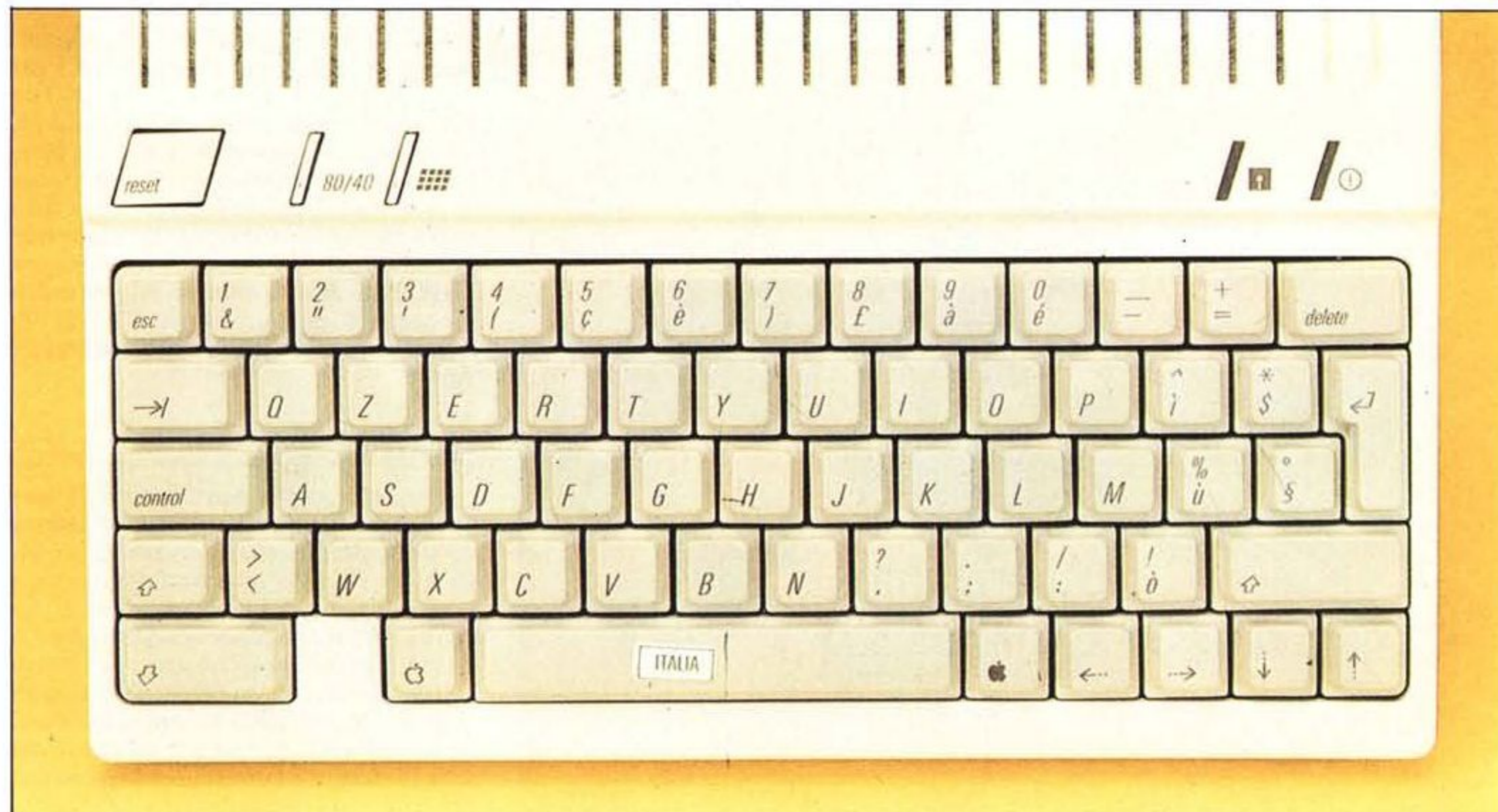
La tastiera dell'Apple IIc è identica a quella del IIe, ma per fortuna sono stati tolti i caratteri bilingue, per cui adesso è una normale tastiera italiana.
