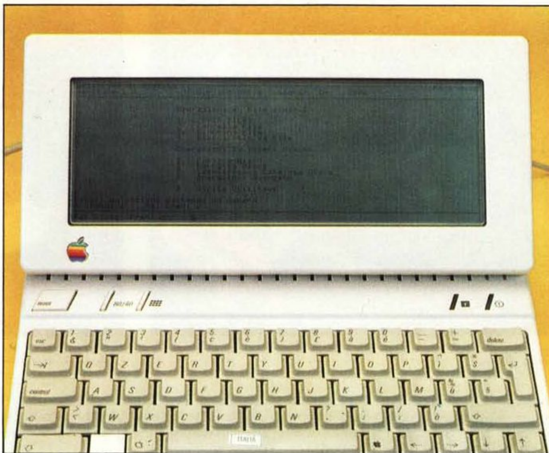
Per aumentare la trasportabilità, l'Apple IIc può essere munito di un display a cristalli liquidi da 80 colonne per 24 righe con possibilità grafiche. Purtroppo, a parte il costo elevato, il display risulta anche scarsamente visibile.
