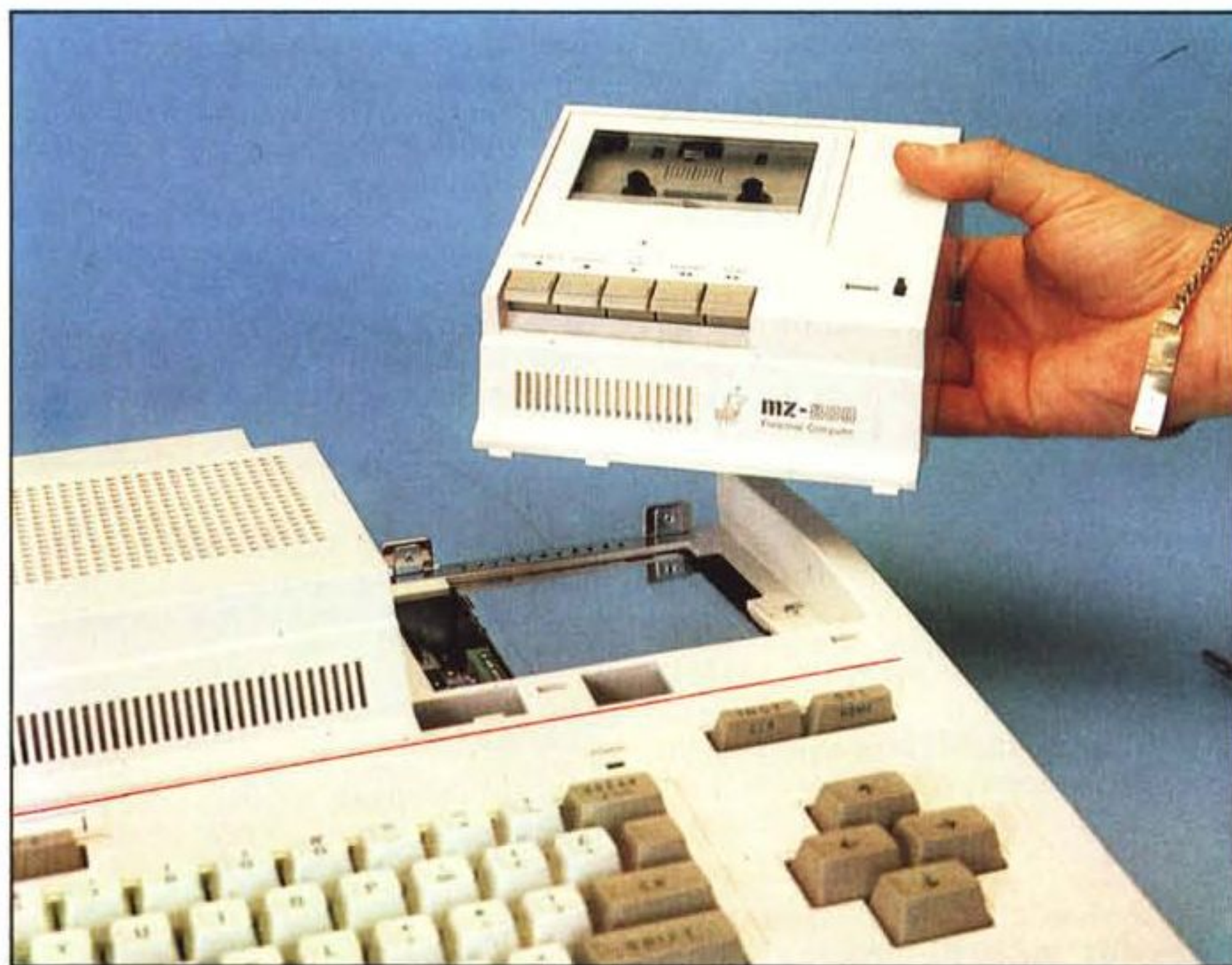
Il registratore a cassette è estraibile per permettere l'alloggiamento, nello stesso vano, del quick-disk.
