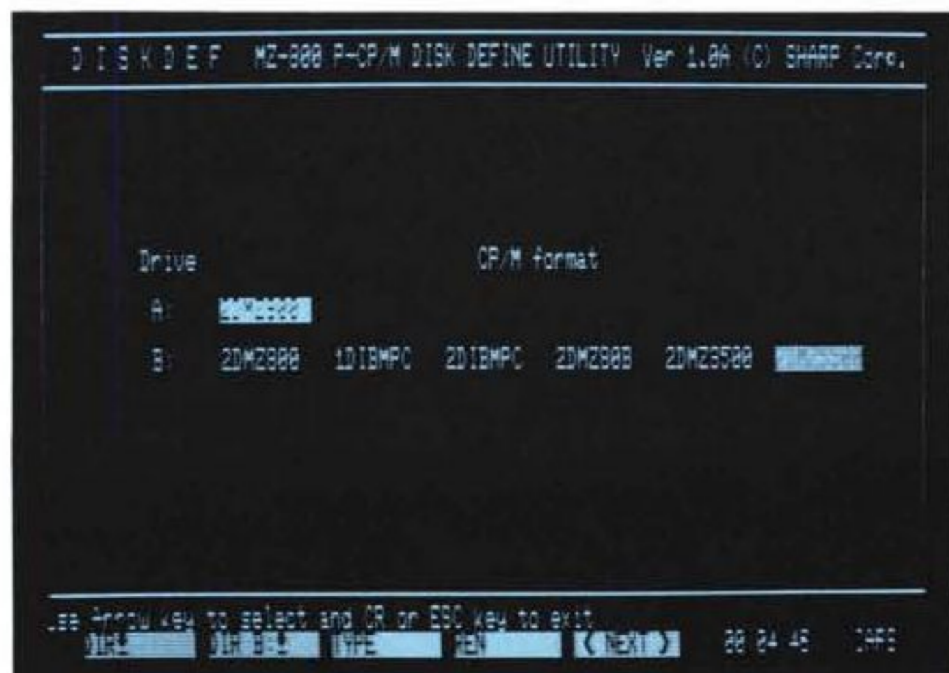
Due esempi di programmi forniti con il P-CP/M. Il DISKDEF permette di definire il formato del disk-drive n.2, mentre con DISK-EDIT è possibile leggere e modificare il contenuto del floppy-disk.
