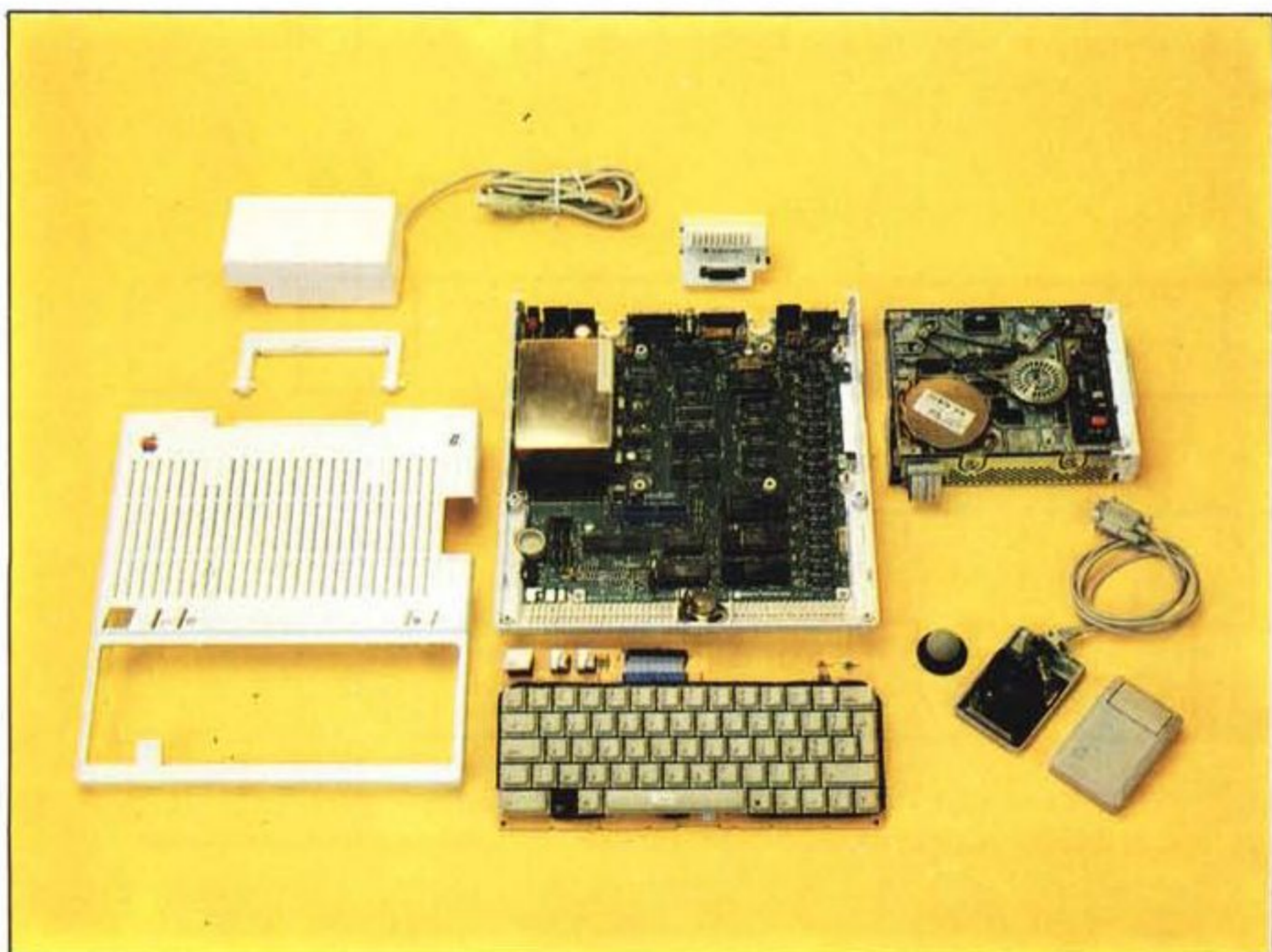
Esplso dell'Apple IIc. Si notano il Drive incorporato da 5" e il grosso alimentatore interno (il parallelepipedo di metallo) che genera tutte le tensioni necessarie al computer.
