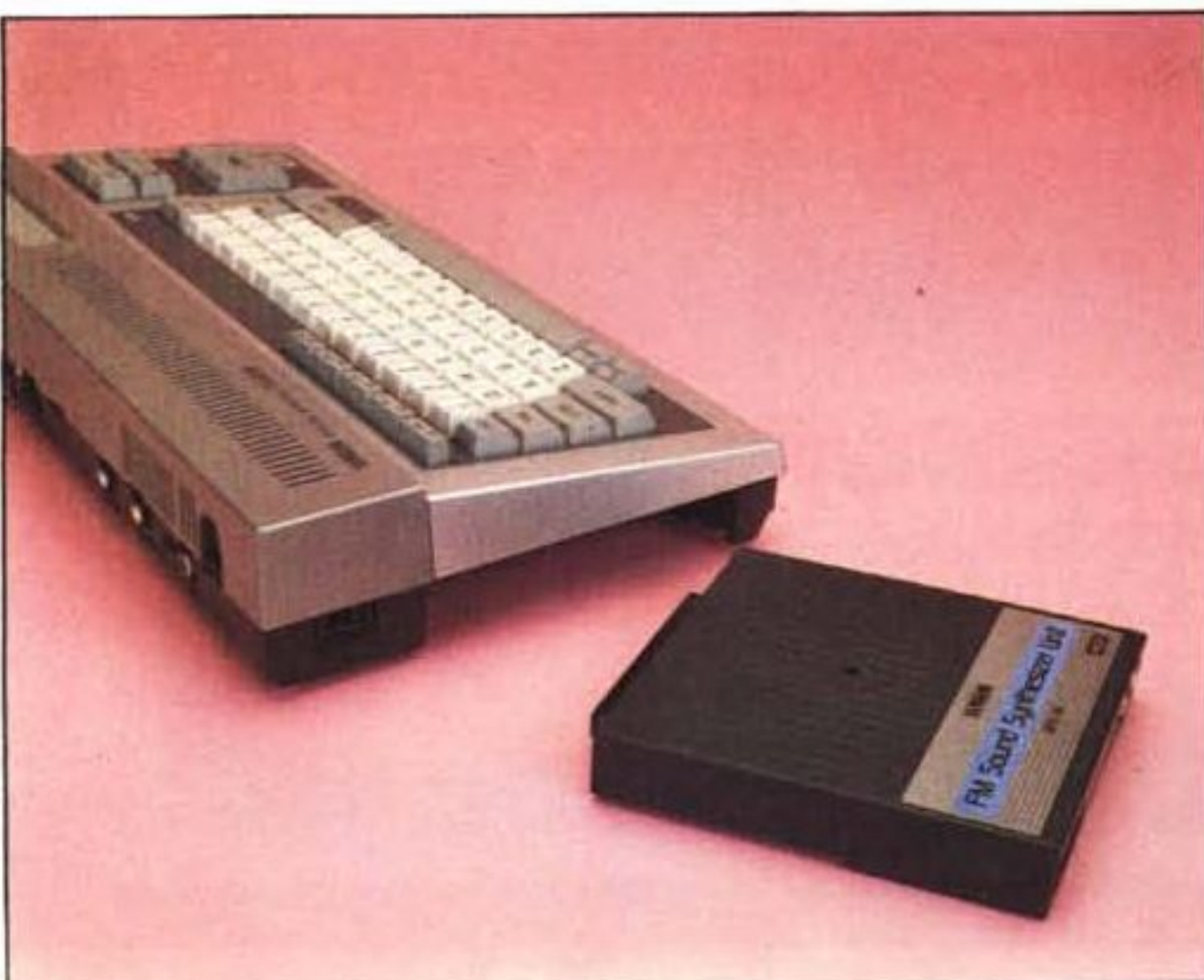
Il modulo di sintesi inserito; si vedono l'attacco per tastiera e i due spinotti PIN dell'uscita audio stereofonica.
