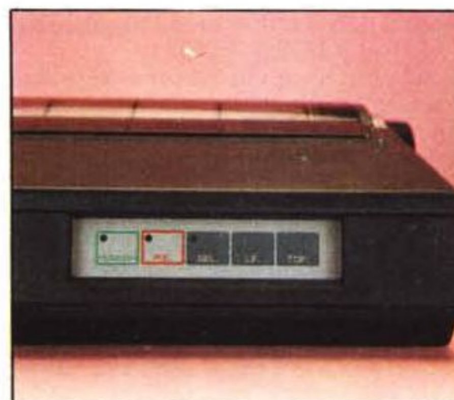
Gli interruttori sul pannellino frontale sono a sfioramento.
