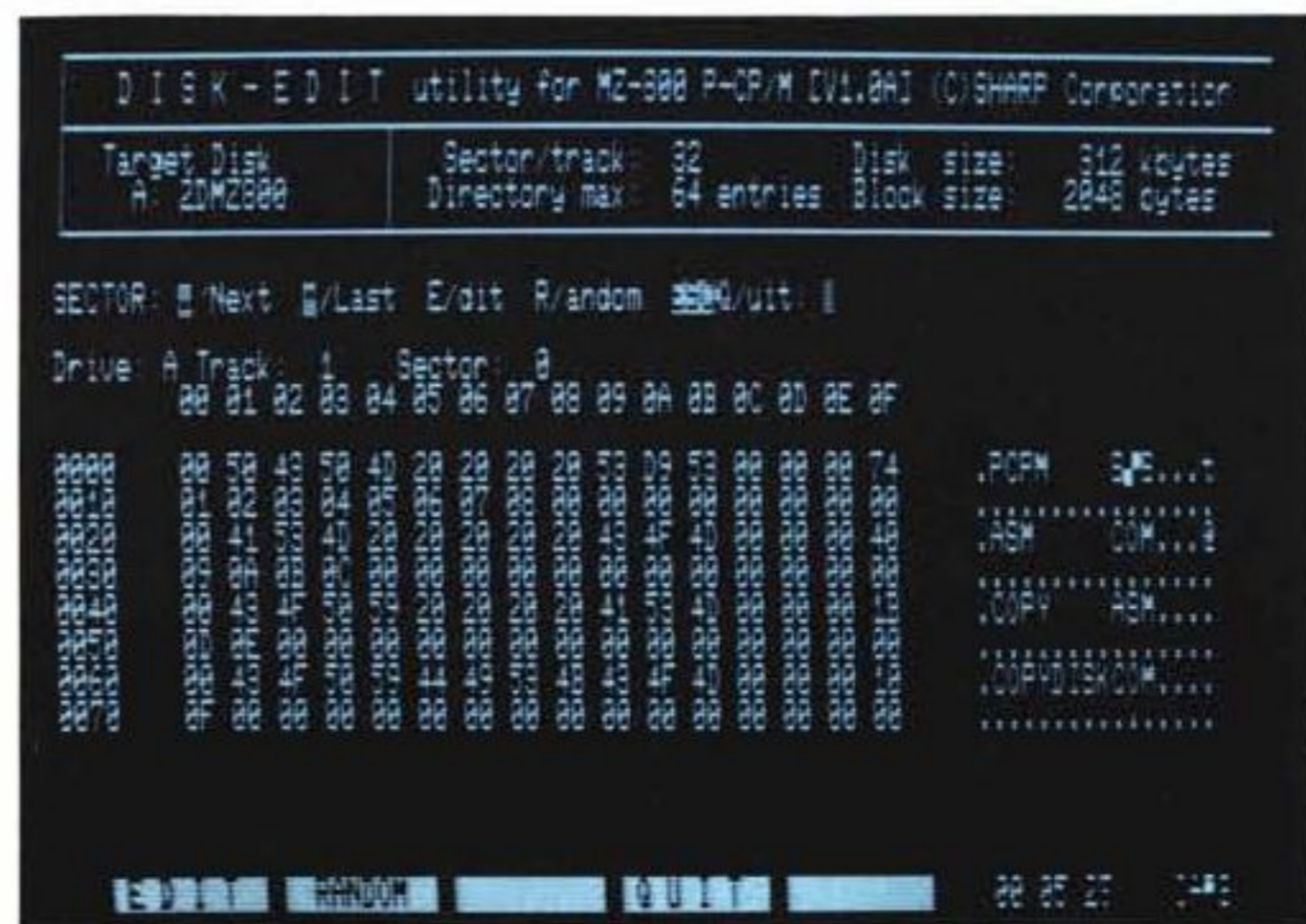
Due esempi di programmi forniti con il P-CP/M. Il DISKDEF permette di definire il formato del disk-drive n.2, mentre con DISK-EDIT è possibile leggere e modificare il contenuto del floppy-disk.
