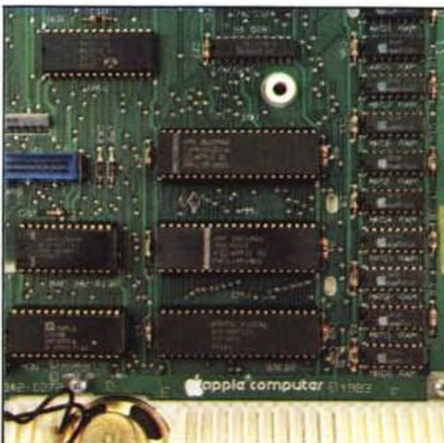
In primo piano la CPU 65C02, e gli integrati realizzati appositamente per la Apple. Vicino (a sinistra) le ROM, mentre sulla destra si vedono alcuni dei 16 chip della RAM.
