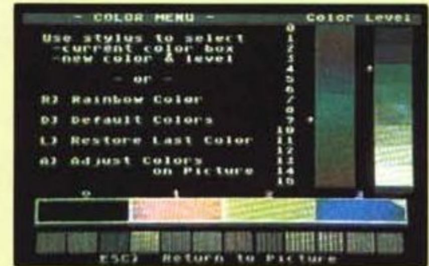
La tavoletta grafica è una periferica estremamente piacevole da utilizzare. Il pulsante sul corpo dello stilo consente di scegliere le opzioni presenti nei due menu disponibili: quello principale (in alto a destra) e quello dei colori (in basso a destra).
