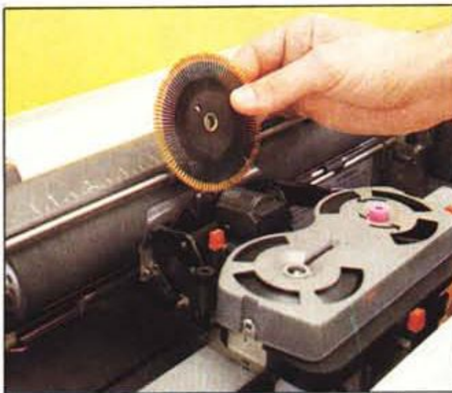
Come si inserisce la margherita. Dopo averla lasciata cadere nel suo alloggiamento si spinge il bottone rosso poi pensa a tutto la macchina.
