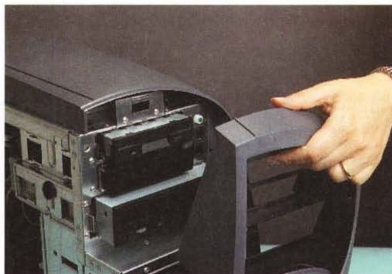
Per rimuovere il frontale è necessario sbloccarlo, premendo verso l'alto un pulsante nascosto all'interno del vano delle memorie di massa rimovibili, e tirarlo a sé una volta svincolato.
