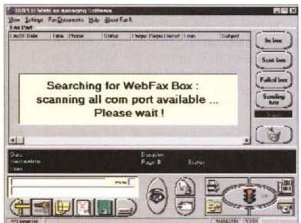
La fase di ricerca di WebFax Box; la procedura avviene, in fase di setup, una tantum, e, successivamente, in forma semplificata, ogni volta che si lancia il servizio.
