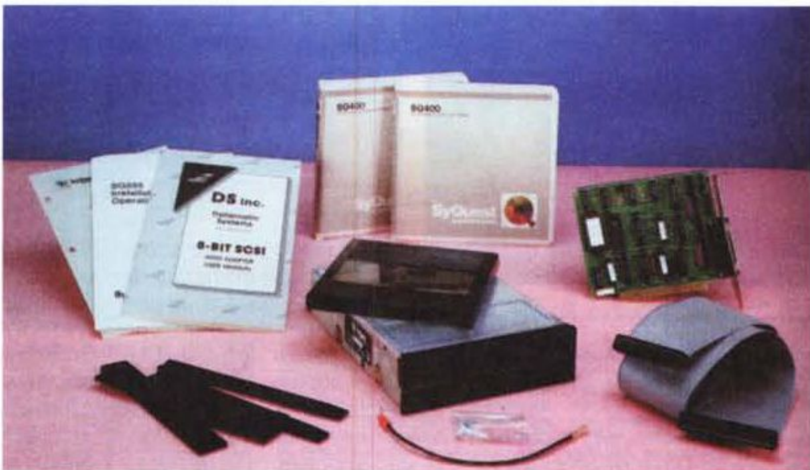
Eccolo qui, il padre di tutti gli ZIP. Il SyQuest, da ben 44 MB (non pochi dieci anni fa) ha rappresentato per lungo tempo uno standard de facto, specialmente in campo grafico, riguardo i supporti di massa removibili ad alta capacità. L'unità costava quasi tre milioni, ogni cartuccia 270.000 lire!
