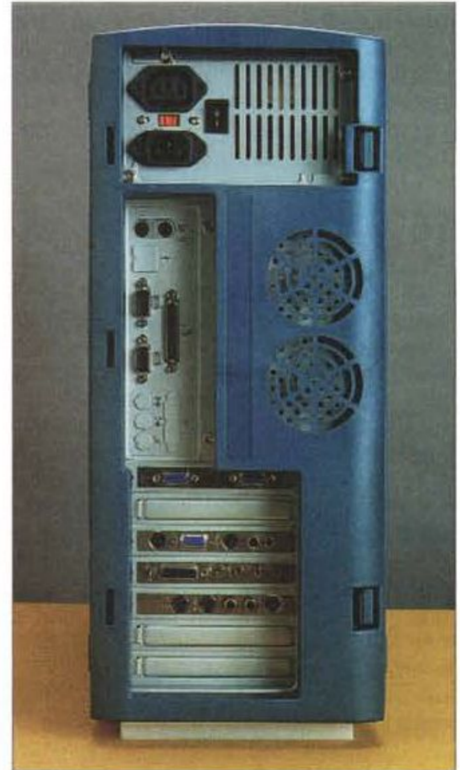
Il pannello posteriore in plastica può essere facilmente rimosso manualmente per lo smontaggio dei due pannelli laterali, a loro volta agganciati al telaio del mobile mediante clip. Il retro del mobile presenta numerose forature per l'uscita dell'aria calda dall'interno del computer.
