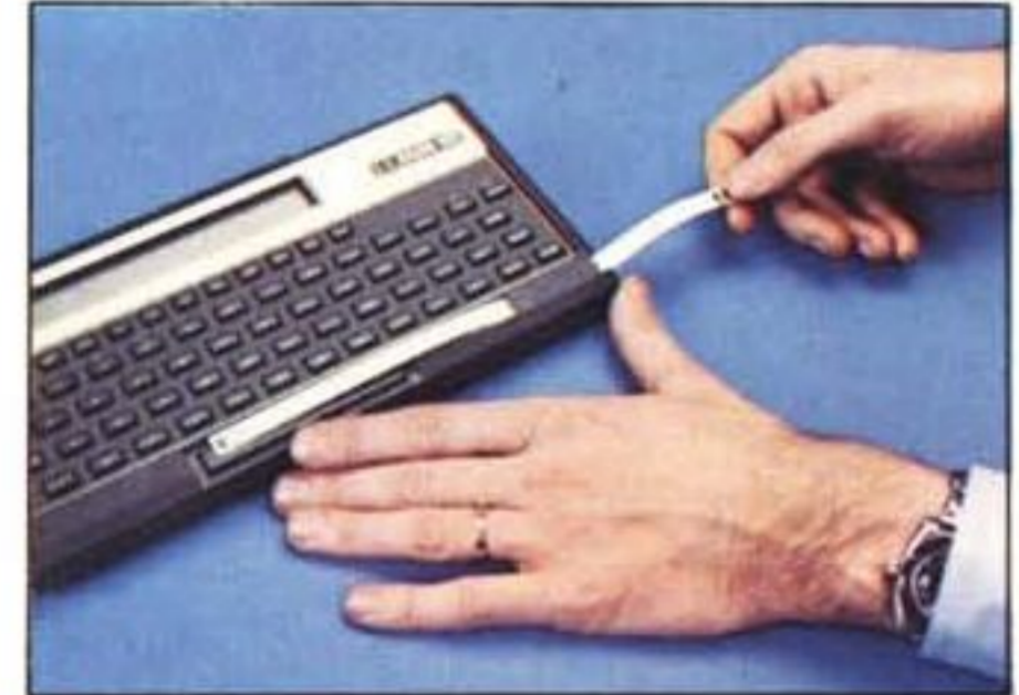
Il lettore di schede a trascinamento manuale: incredibile, ma funziona perfettamente.
