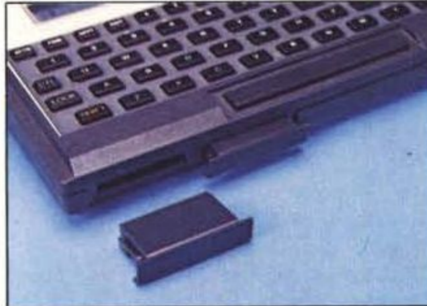
La 75 prevede quattro slot per l'alloggiamento di moduli ROM e RAM.
