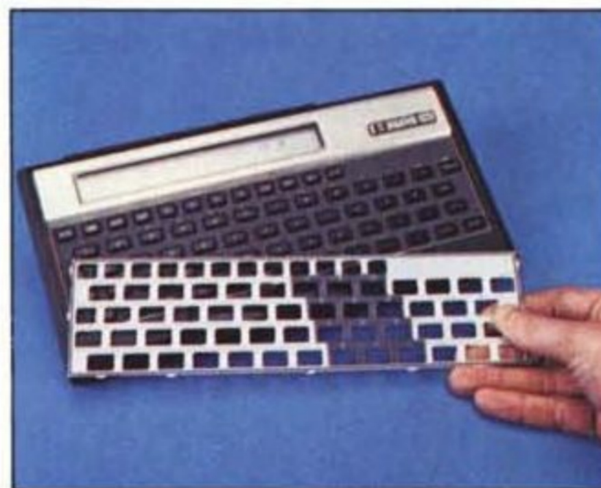
La mascherina del trascinamento numerico: premendo Control Lock sono disabilitati tutti i tasti al di fuori del campo scuro.
