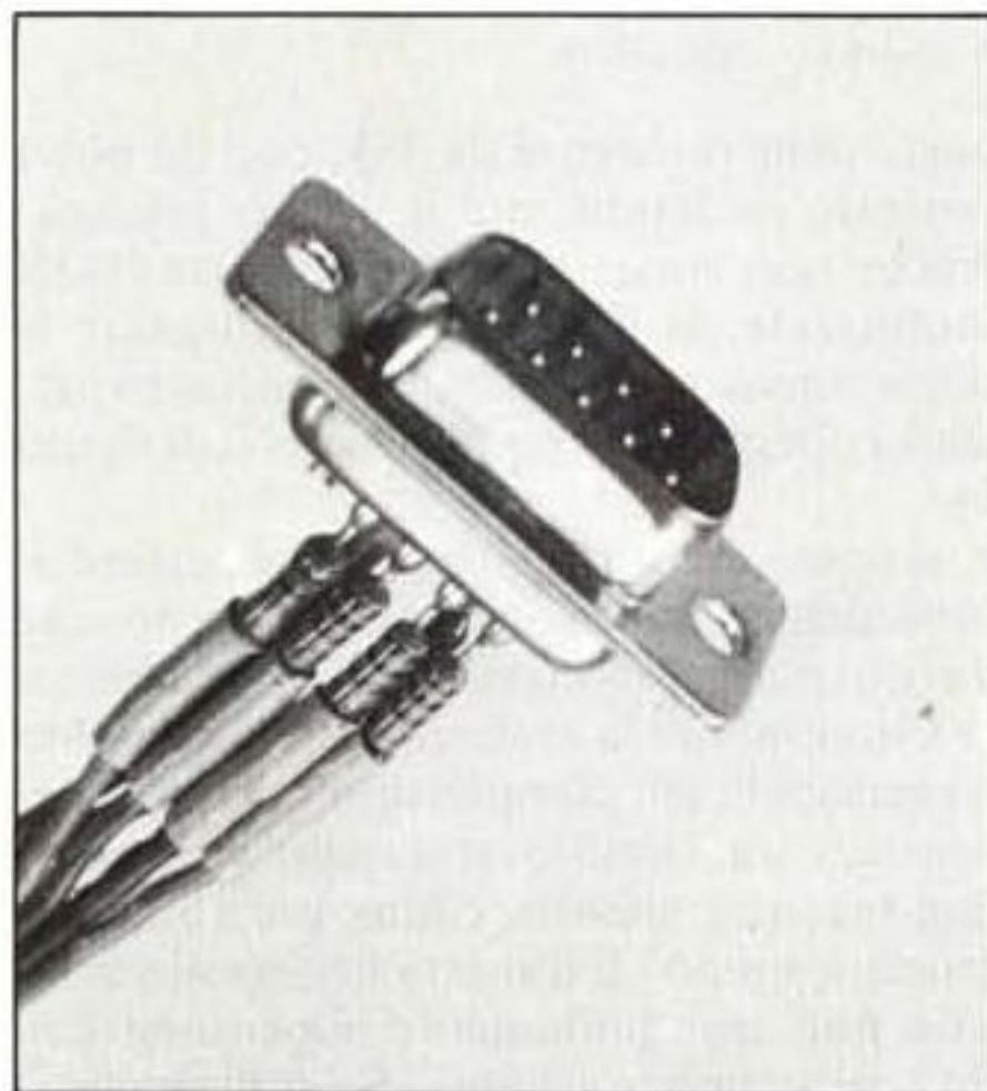
La foto mostra le resistenze anti-conflitto montate direttamente sui piedini del Cannon. La resistenza di pull-down del pulsante Fire è invece montata nello zoccolo da inserire nell'Apple.
