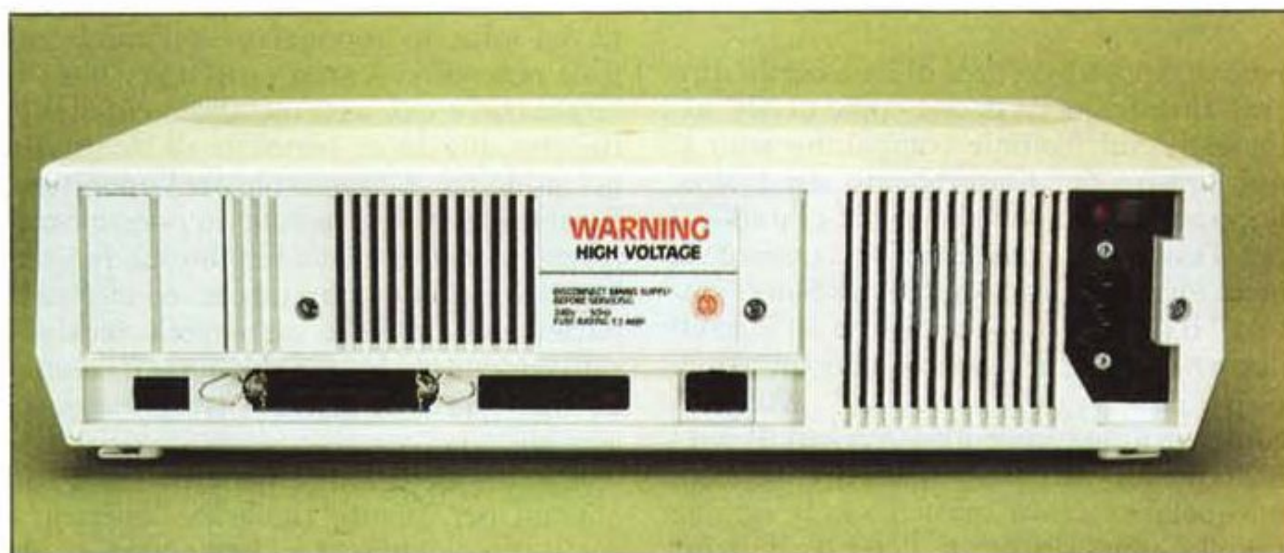
Il retro della macchina, decisamente molto ordinato; dietro alle fessure di destra è posta una ventola di aerazione.
