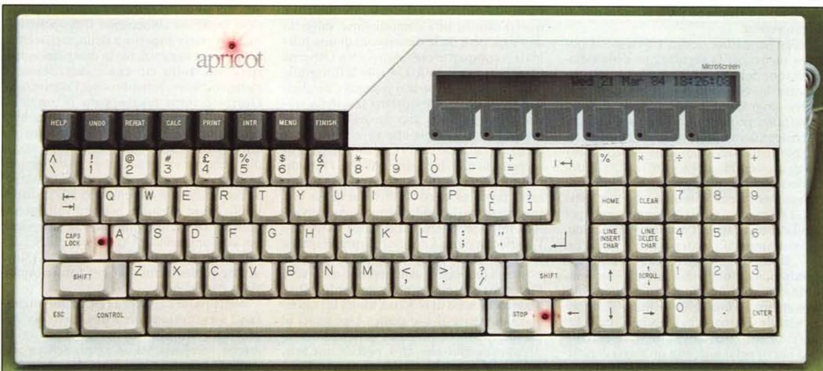
La tastiera (intelligente) dimostra tutta la classe dell'Apricot; notare il display a cristalli liquidi che funziona da calendario.
