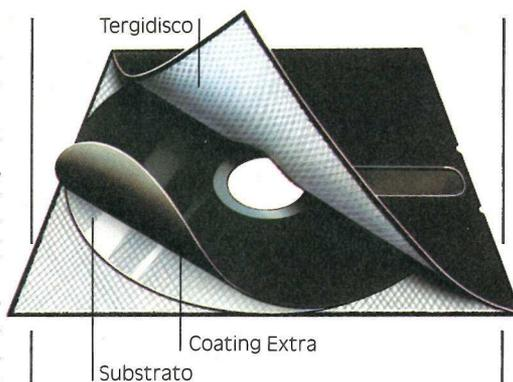
ambiente a livello di polverosità rigorosamente controllato; ciò garantisce il floppy disk Diaspron esente da particelle contaminanti di qualsiasi tipo, causa principale del "Soft Error".
