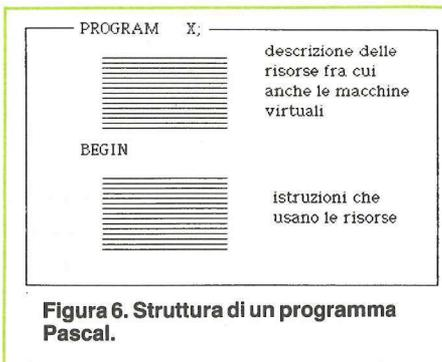
**Figura 6. Struttura di un programma Pascal.**
