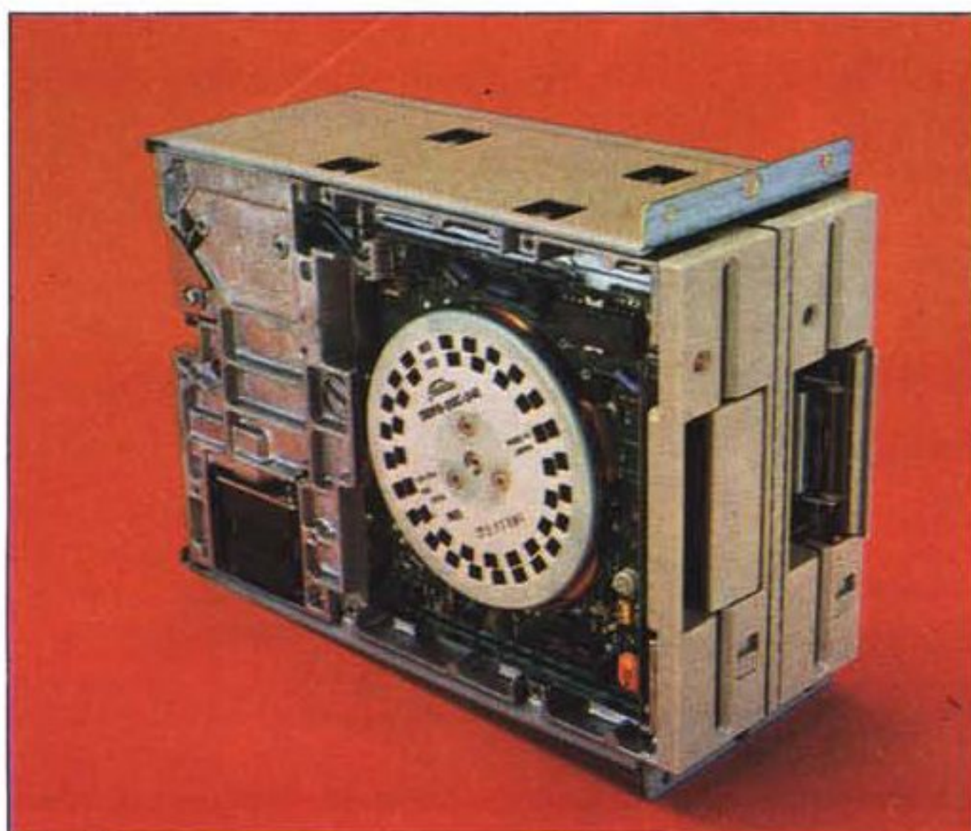
Due immagini dei drive per i floppy. A sinistra vediamo un drive smontato; notare le tacche stroboscopiche sul volano. Sopra un particolare che mostra la "sicura" che impedisce l'apertura dello sportellino.
