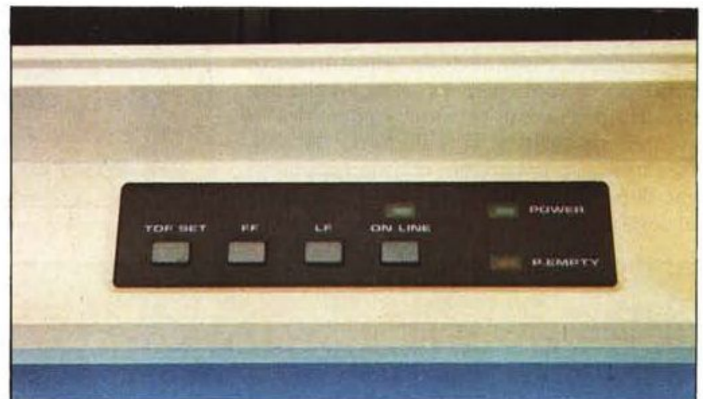
Due particolari dei pannellini di controllo. A sinistra, i selettori di modo e il tasto Reset; sopra, gli altri tasti operativi e le spie.
