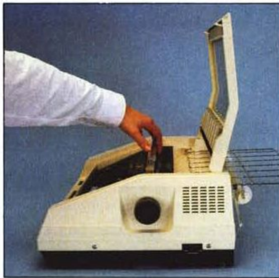
Per inserire la carta occorre ribaltare in avanti la barra con i cingoli di trascinamento.
