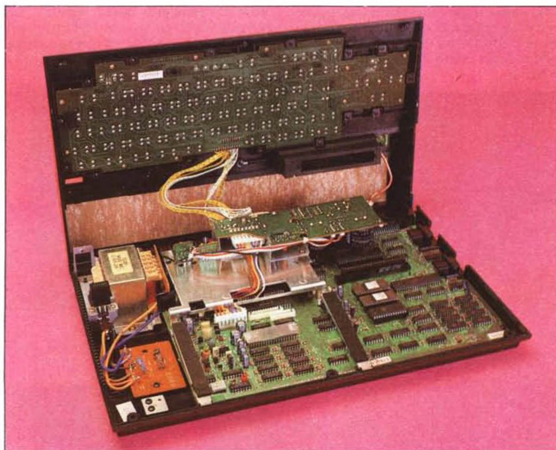
Il Sony HB-75 aperto. Sulla sinistra si nota il trasformatore di alimentazione, per una volta interno al computer anziché esterno.
