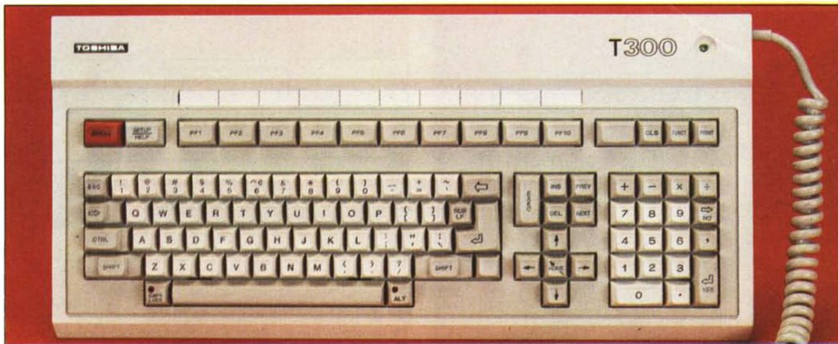
Un primo piano della tastiera. La dotazione di tasti è piuttosto ricca: il tastierino numerico comprende anche i simboli di operazione.
