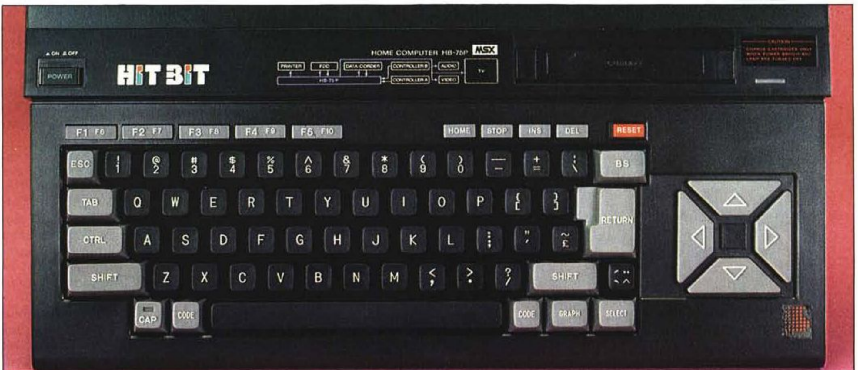
La tastiera è molto comoda, grazie alla morbidezza dei tasti. In alto a sinistra si può vedere l'interruttore di accensione; a destra lo slot per cartucce ROM.
