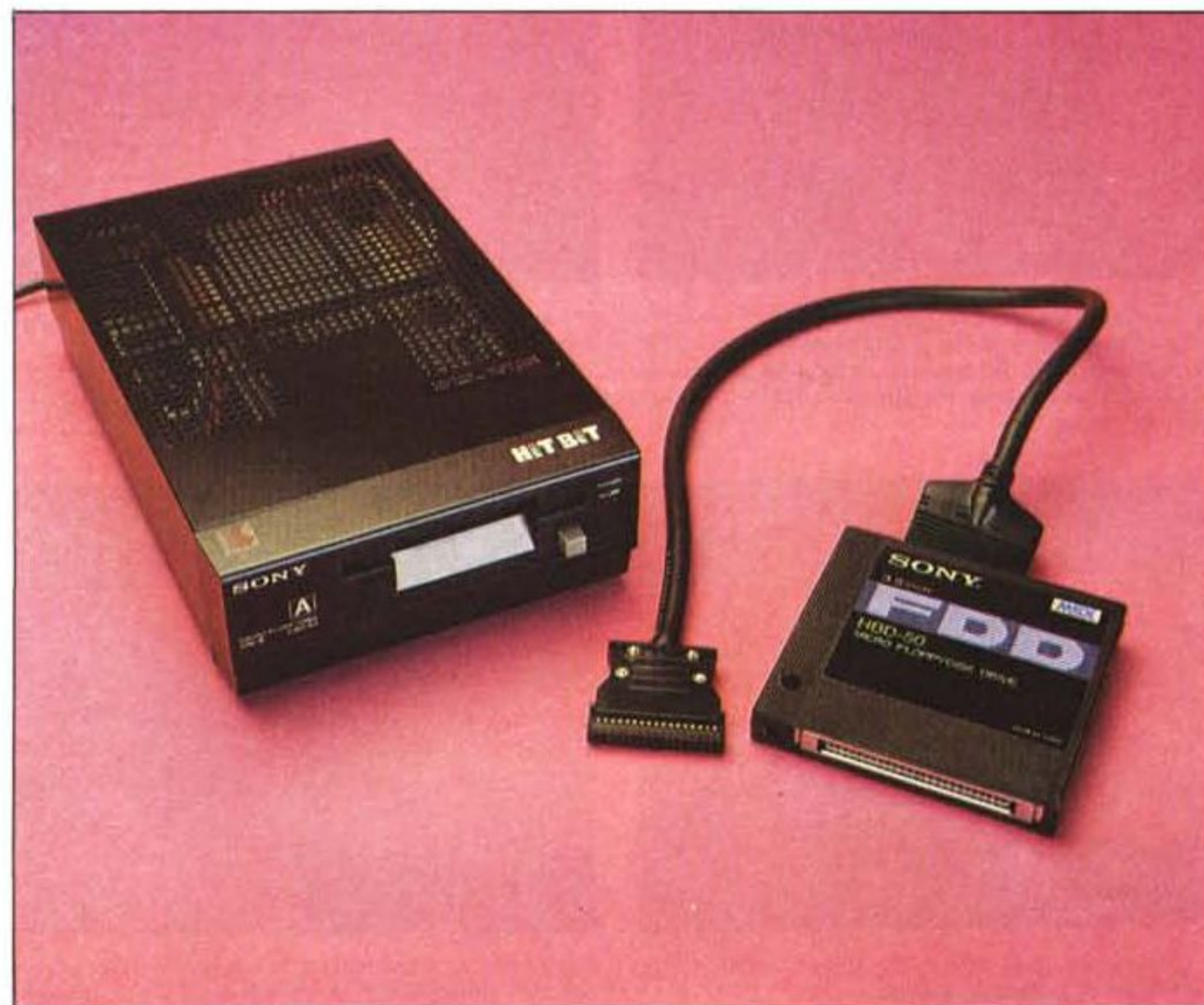
Il drive per floppy disk impiega dischetti da 3.5"; la capacità è di 360 Kbyte (formattati) per disco.
