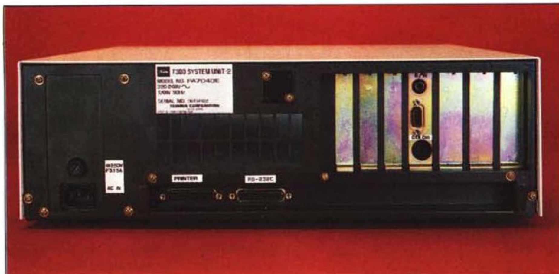
Il pannello posteriore. Sulla destra vi sono gli alloggiamenti per le schede di espansione.
