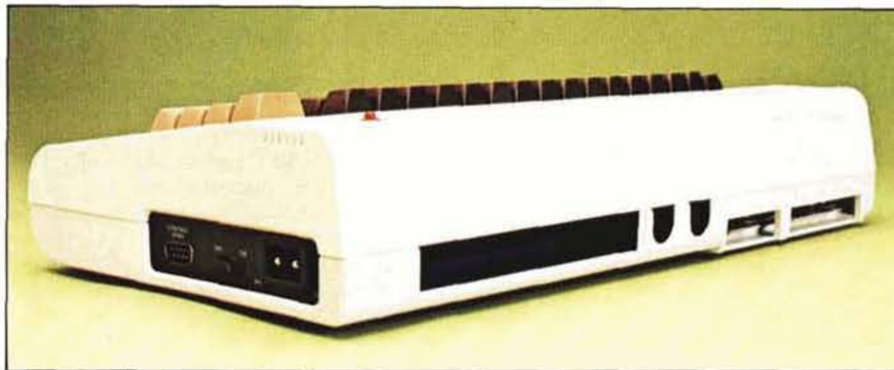
Gli slot e i connettori sono posti sul retro e sul lato destro.
