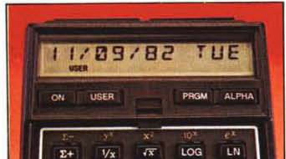
Richiamando sul display la data, con la funzione DATE, ecco come appare nei due formati DMY (a sinistra) e MDY (a destra)
