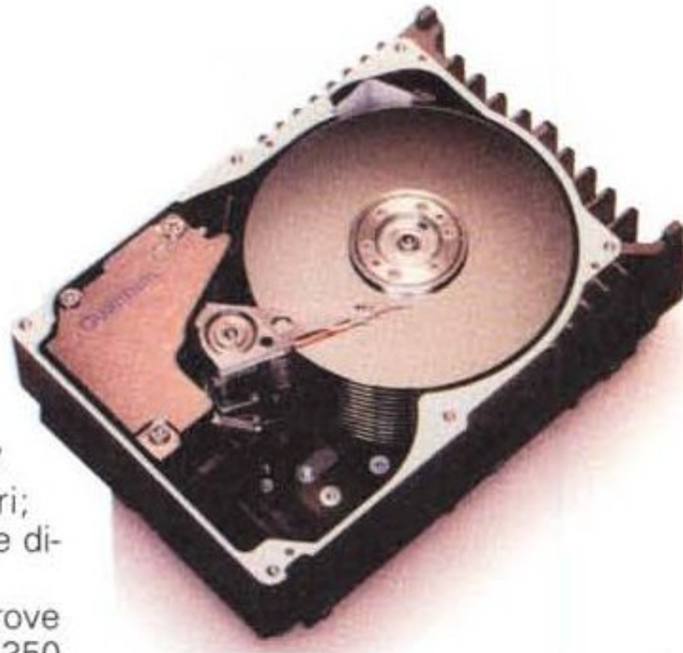
L'interno del disco rigido Quantum Atlas 10K e dell'IBM Ultrastar LZX, entrambi a 10.000 RPM.
