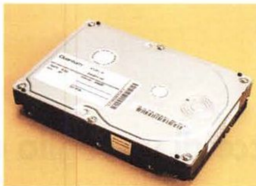
Il disco rigido preso come riferimento, il Quantum Atlas IV.
