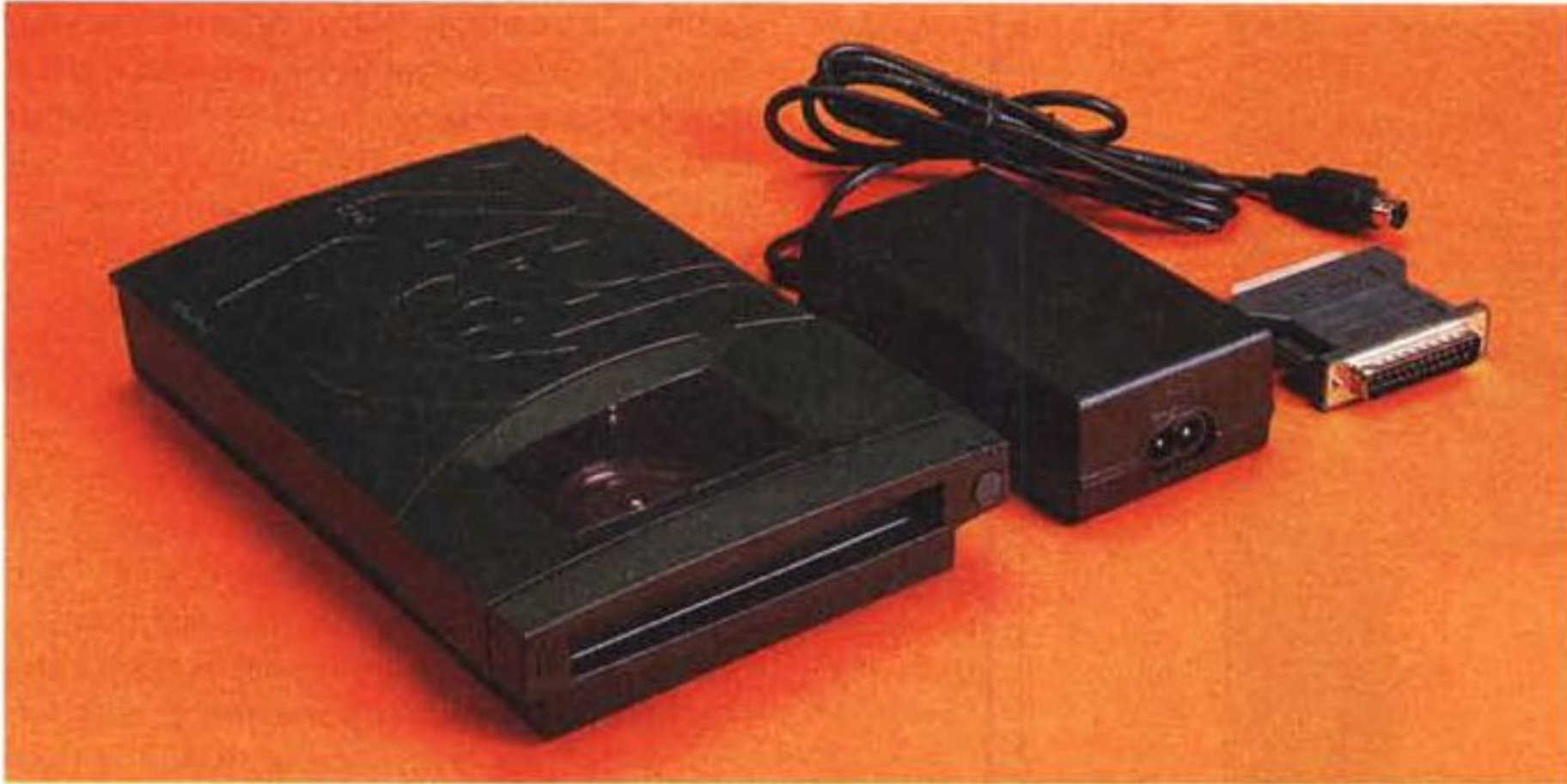
Il drive Iomega Jaz è praticamente diventato lo standard per l'interscambio dei dati e viene molto usato negli studi di registrazione. L'unità in dotazione è quella di 2 giga.
