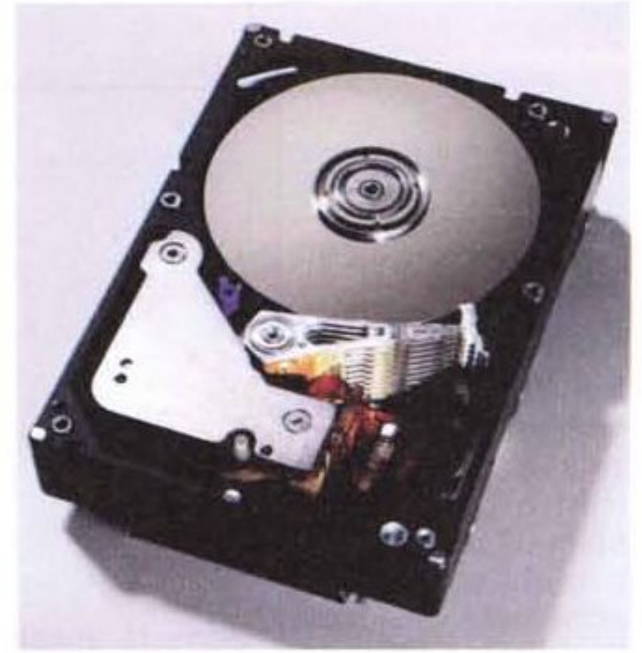
L'interno del disco rigido Quantum Atlas 10K e dell'IBM Ultrastar LZX, entrambi a 10.000 RPM.
