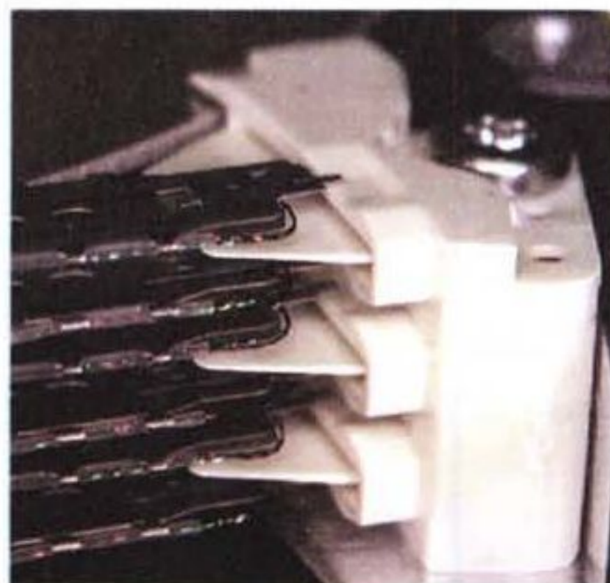
Dettaglio delle testine dell'IBM Ultrastar LZX con le testine bloccate dagli elementi del Load/Unload Ramp.
