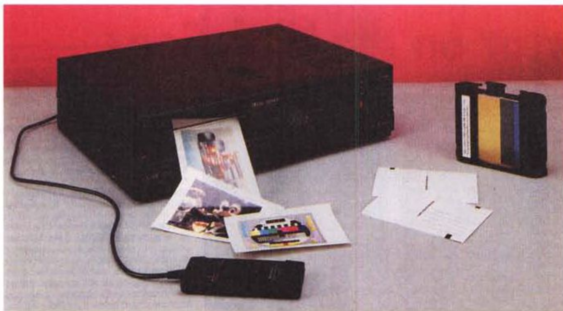
Quando le stampanti a getto d'inchiostro (come quelle attuali) di qualità fotografica erano ancora un sogno, per stampare decentemente a colori si doveva ricorrere necessariamente alle "tecnologie alternative", come la costosa stampa a sublimazione termica. L'Hitachi VY-25E non si collegava in digitale al computer ma accettava solo ingressi video, composito o RGB.
