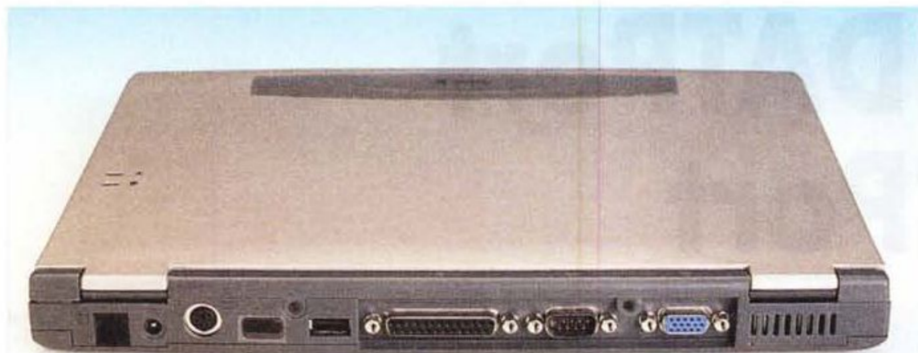
Sul pannello posteriore troviamo le prese per il modem, l'alimentazione, la tastiera esterna, la porta USB, la stampante, la porta seriale e l'uscita per monitor esterno.
