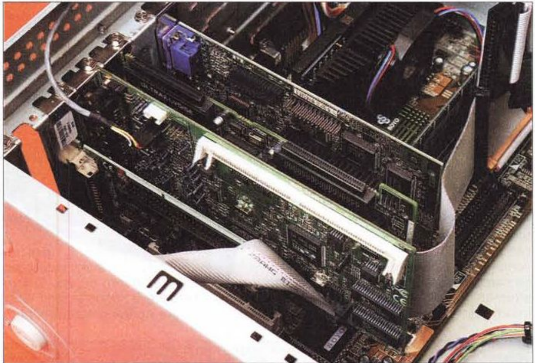
Queste schede sono il cuore del computer. Dall'alto verso il basso: la scheda video Matrox G400 Dual Head, al top delle prestazioni nella sua gamma, il controller Adaptec AHA-2940, la scheda audio Guillemot, il controller SCSI per il Jaz, l'Adaptec AVA-2904 e la schedina di collegamento per il box esterno con i convertitori audio, nascosta per la verità dal pannello di fondo del case.
