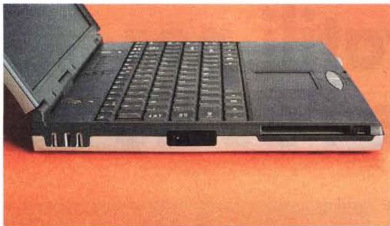
Lateralmente troviamo sia la porta USB che l'alloggiamento per una scheda PCMCIA, utile per il collegamento di periferiche come la WaMi Box o schede audio PCMCIA professionali.
