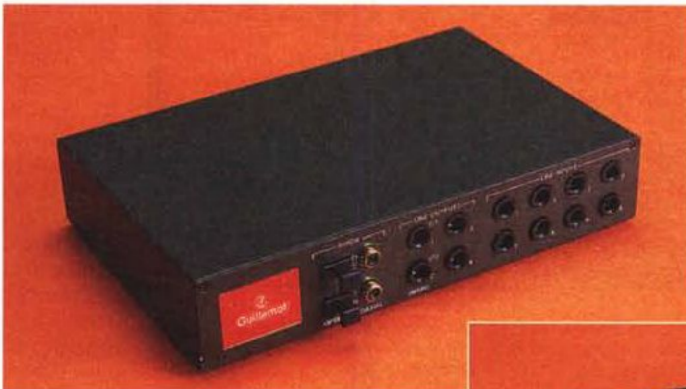
Sul box esterno troviamo tutte le connessioni audio della scheda ISIS, abbiamo in tutto otto ingressi analogici, quattro uscite, sempre analogiche, e una coppia di prese per l'i/o digitale, sia elettriche che ottiche.
