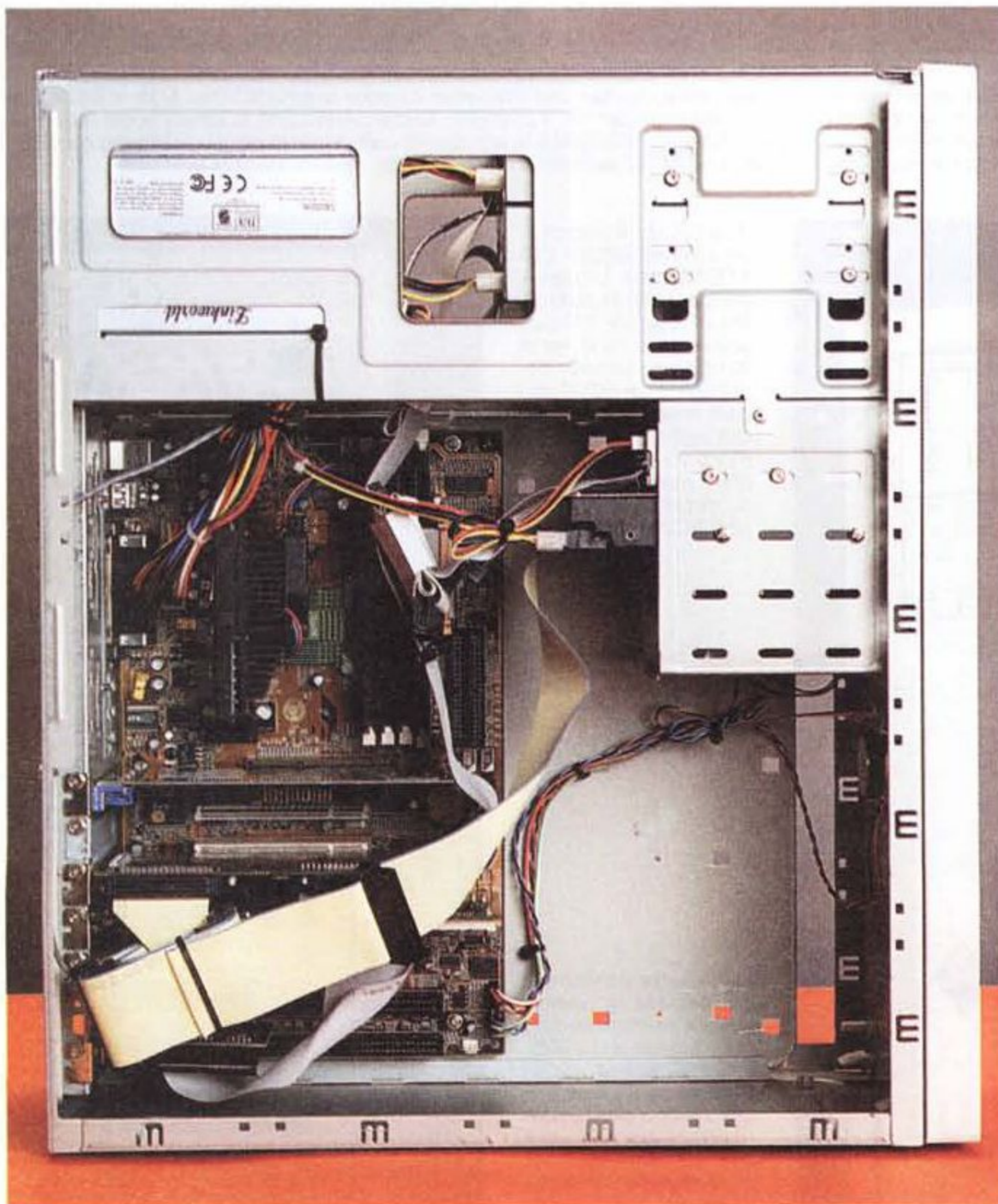
L'interno del computer rivela un montaggio accurato, con i pochi fili volanti accuratamente bloccati.
