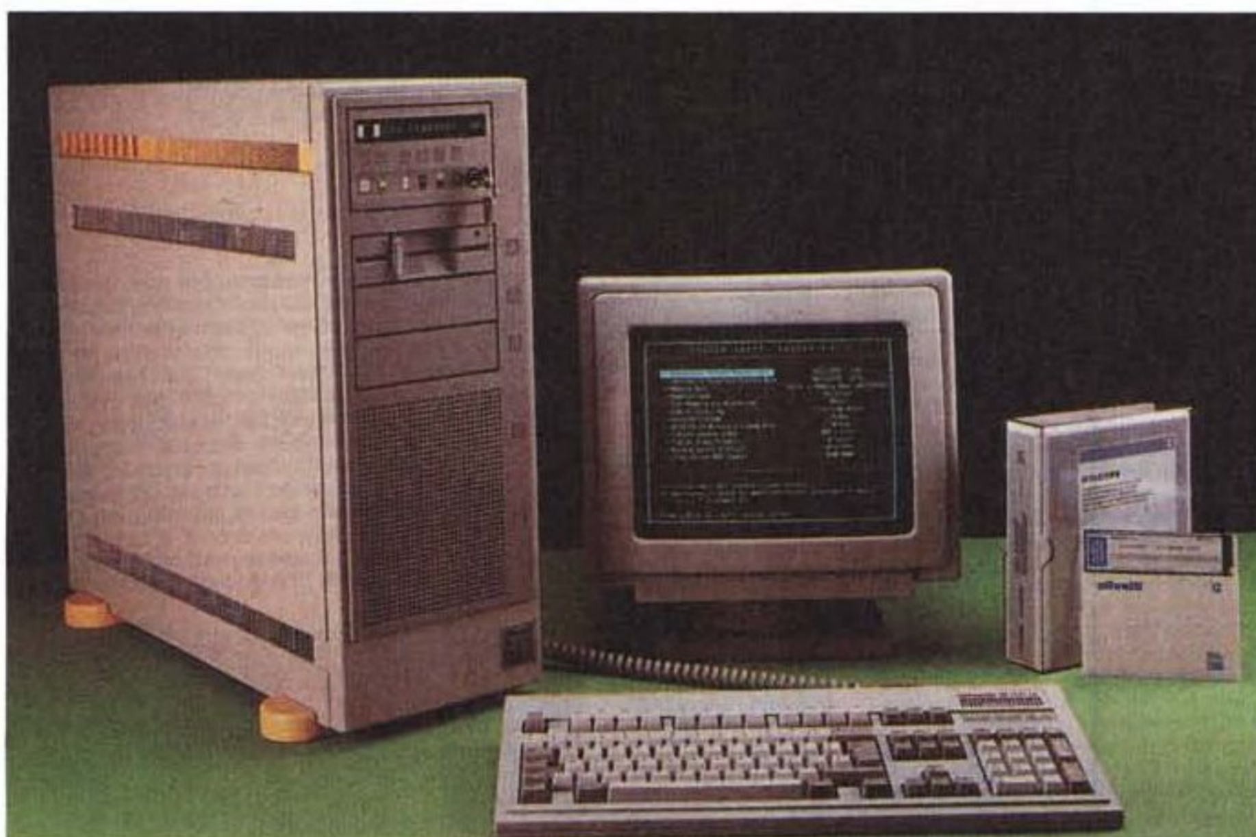
L'Olivetti M380/XP9 era una macchina "seria". Come scriveva Corrado Giustozzi nell'articolo, "tale vocazione di sistema multiutente è confermata anche dalla sua struttura interna che prevede, ad esempio, una dotazione standard di 4 MByte di RAM espandibili ad 8 MByte su piastra madre...". Che tempi!
