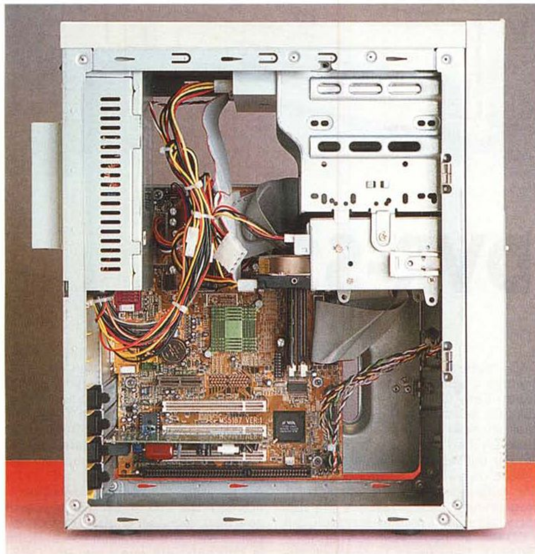
Particolare del sistema di fissaggio delle schede di espansione, interessante in quanto costituito da una slitta autobloccante senza viti.
