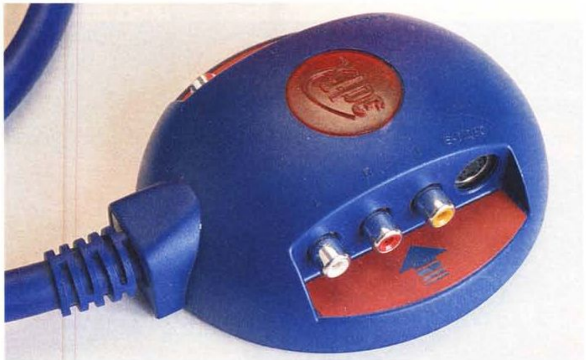
L'External AV Control Pod è uno scatolotto esterno, a forma di semisfera, che contiene tutte le prese di ingresso e di uscita, sia audio che video, per il collegamento a telecamere o videoregistratori.
