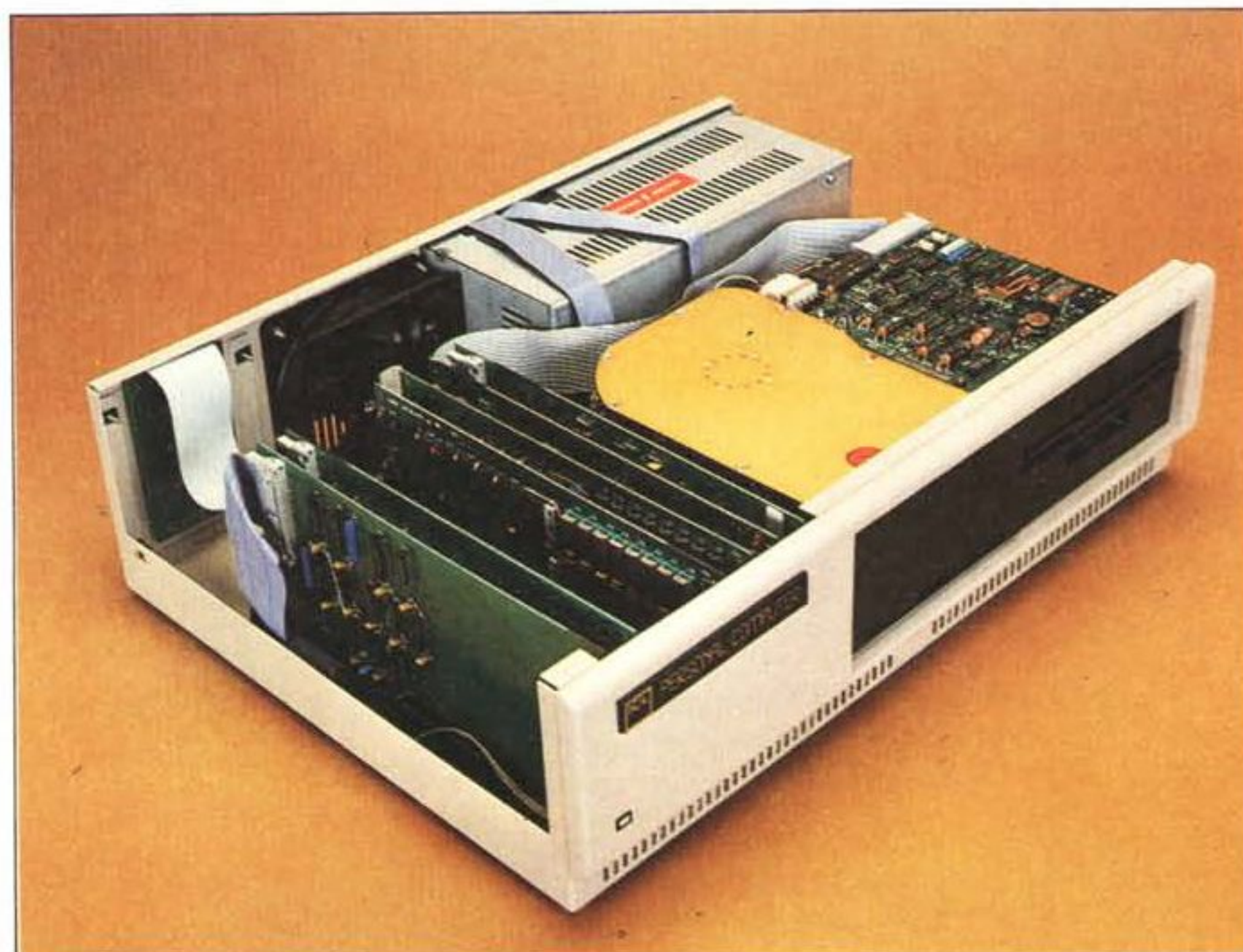
L'unità centrale aperta. Notare la modularità della costruzione: da sinistra a destra troviamo l'elettronica, il winchester e il drive per i floppy; sul fondo l'alimentatore.
