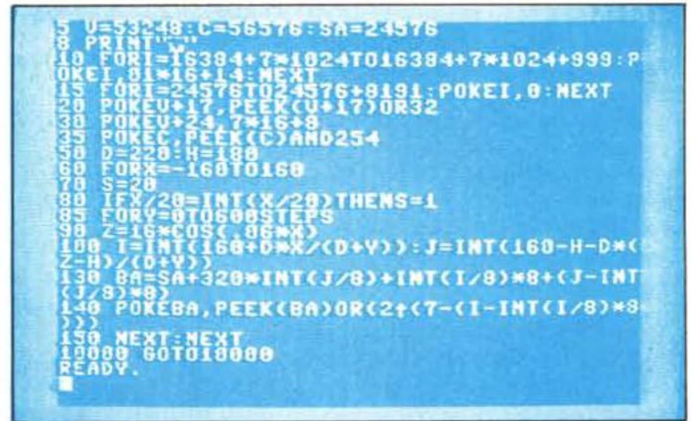
Presentazione del testo su una pagina di 25x40 caratteri. Si tratta delle dimensioni ideali per essere osservate su un televisore a colori.
