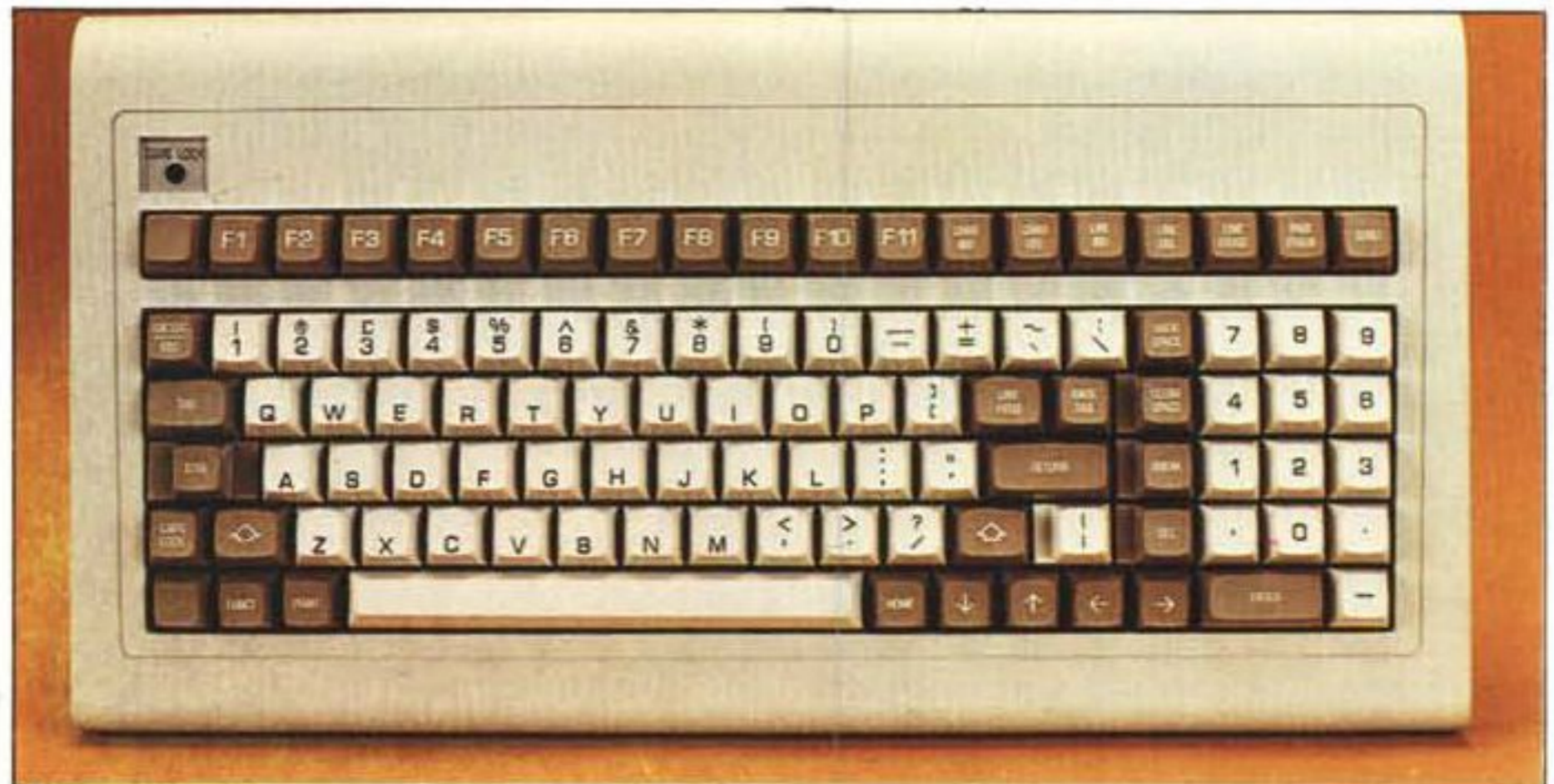
La tastiera coi tasti di colore diverso a seconda della funzione. Il led in alto a sinistra segnala lo Shift Lock.
