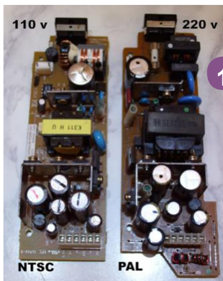
Prima di tutto, le due sezioni di alimentazione. Come potete vedere sono decisamente diverse tra loro.
