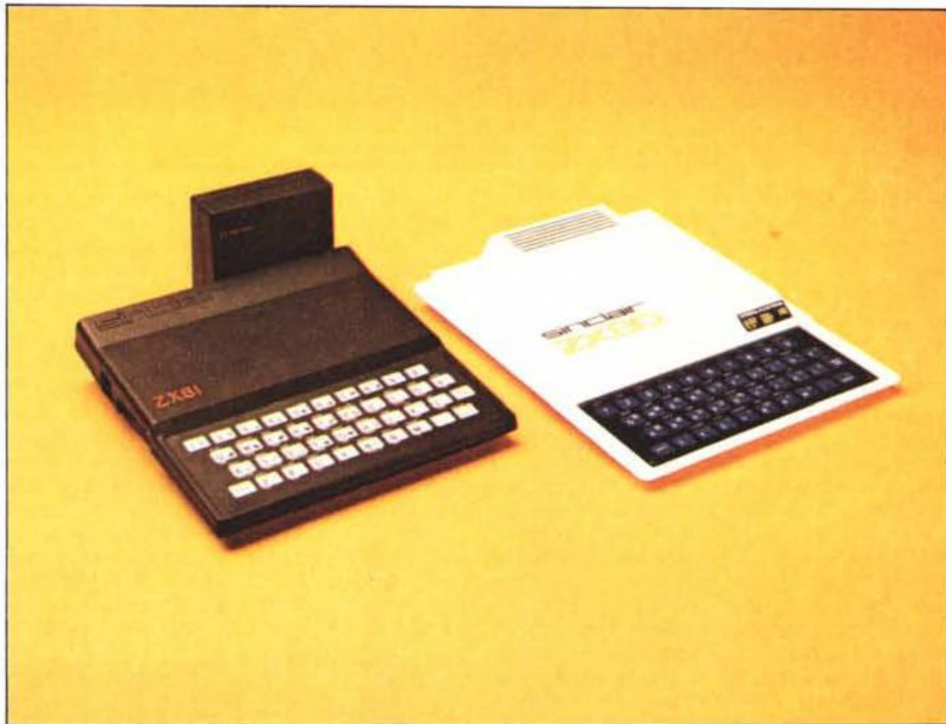
Lo ZX81 a confronto con lo ZX80. Le dimensioni della nuova macchina sono, come si vede, abbastanza sensibilmente più contenute nel nuovo modello.
